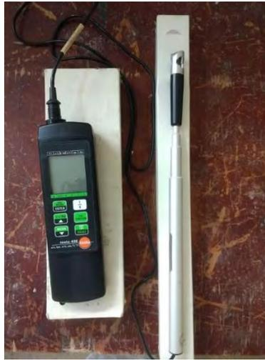
Figura 1.3: Anemómetro de rotación
