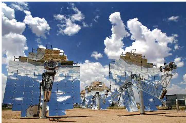
Figura II.12. Discos parabólicos con motor Stirling
