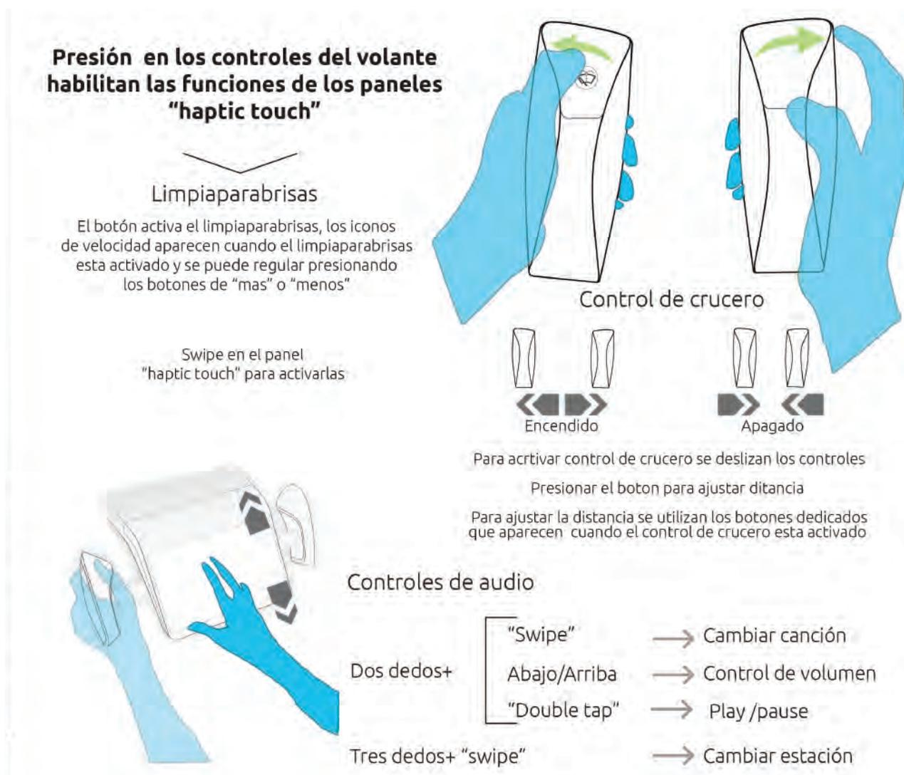
**Figura 21.** Detalles de operación del segundo concepto de: Limpiaparabrisas, señales de giro, control de manejo y controles de audio.
