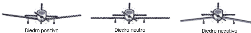
Figura 5 Tipos de Diedro [Fuente: http://aeronautica.conocimientos.com.ve/2009/12/estructura-del-avion_11.html ]
