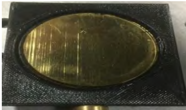
Fig. 4.1 Fotografía de una de las superficies rugosas unidimensionales utilizadas en este experimento y fabricada en el Centro de Investigación Científica y de Educación Superior de Ensenada (CICESE).
