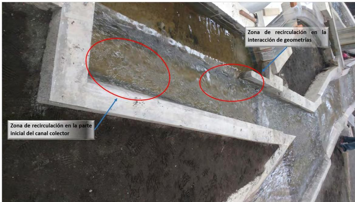
**Figura 7.5** Zonas de recirculación presentes sobre el modelo físico.
