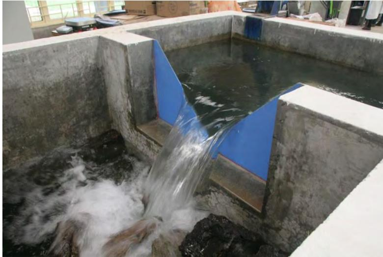
*Figura 4.2 Vertedor Triangular, para aforo de gasto*
