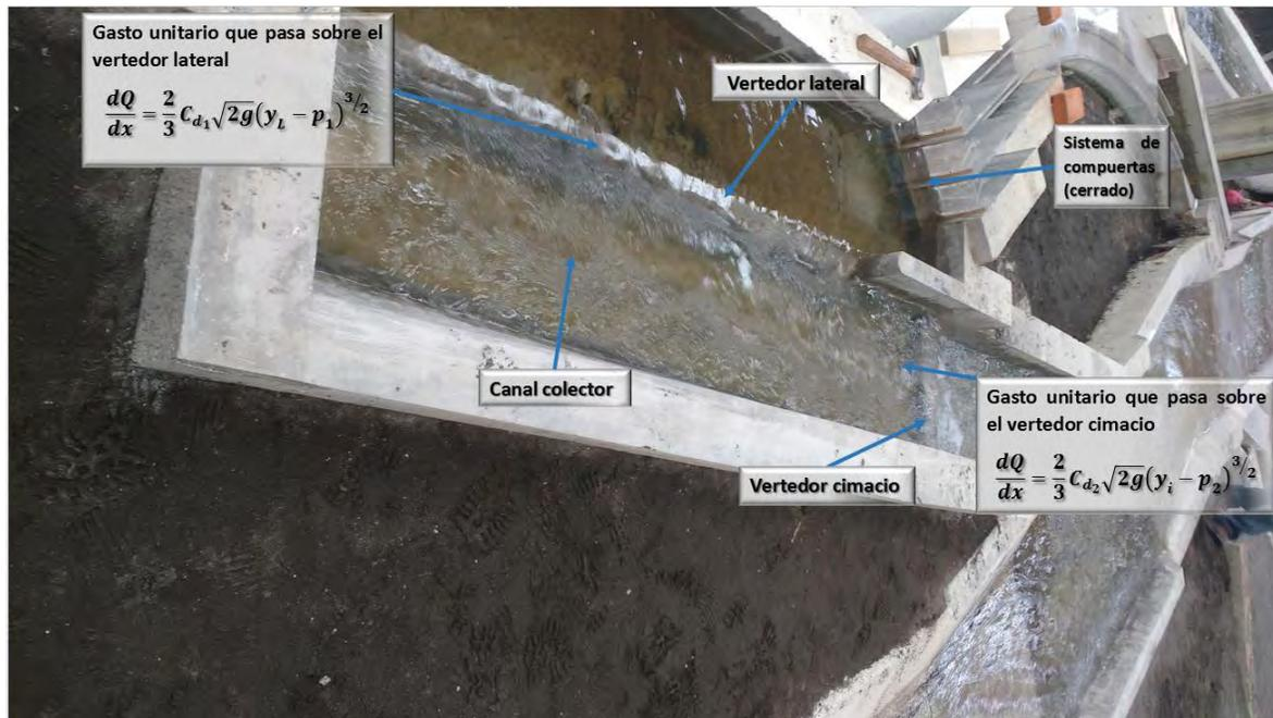
Figura 5.4 Deducción matemática de salida y entrada de flujo mediante el modelo físico.
