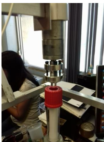
Fig. 44: Vista final del sistema de agitación.
