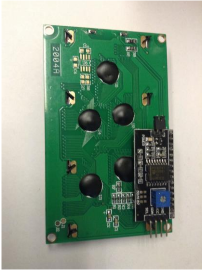
Fig.32: Última vista del montaje del convertidor y el Display (parte trasera).
