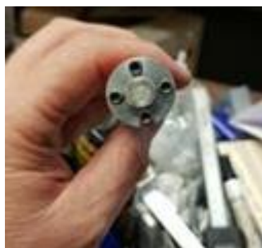
Fig. 42: Adaptando el cople a la flecha de vidrio.
