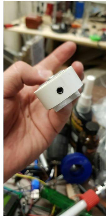
Fig.26: Aro sostén con tornillo de cuerda fina
