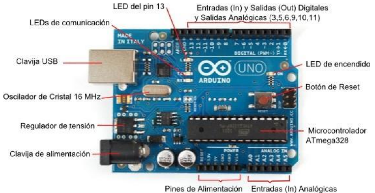
Fig.2 Placa tipo Arduino (microcontrolador).
