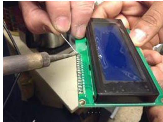
Fig. 31: Asegurando las piezas (soldando).
