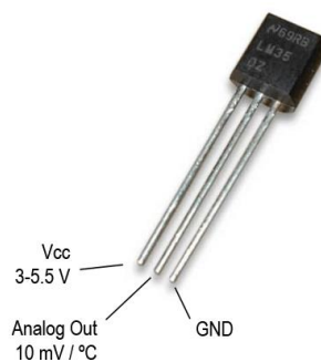
Fig.4: Esquema eléctrico de sensor LM35
