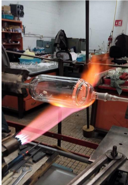
Fig. 55: Sellado de reactor.
