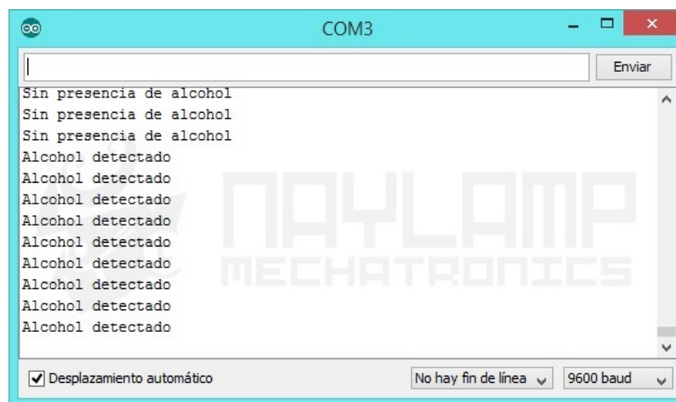
Fig.17: Lectura cuando hay presencia de alcohol con lectura Digital.
