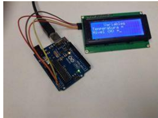
Fig.33: Probando las conexiones haciendo pruebas directamente conectado al Arduino UNO.
