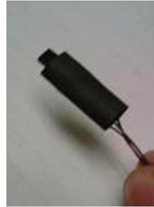
Fig.38: Ajustando el thermofit al área por proteger.
