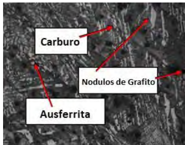
Figura 2.1 Microestructura de una CADI a 200X, mostrando la presencia de Carburos, Ausferrita y Grafito esferoidal (Patil , pathak y Likhite , 2014).
