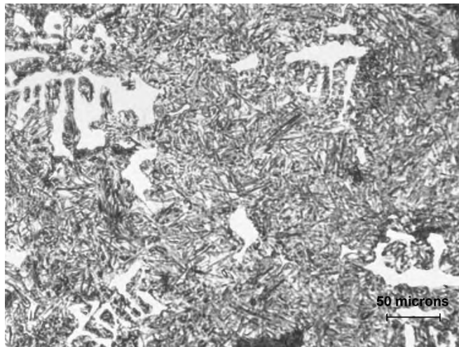
Figura 4.15. Muestra 7 T_{\text{isot}}=350^{\circ}\text{C} y t_{\text{isot}}=20 min, atacada con Nital2, se observa una transformación total a ausferrita.
