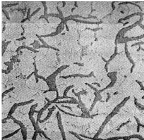
Figura 1.2. Microestructura de un Hierro Gris donde se observa carbono en forma de hojuelas en una matriz ferrítica. (Castro, 2009)
