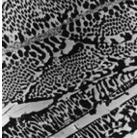
Figura 1.1. Microestructura de fundición blanca característica por tener altos contenidos de carburos (zonas blancas). (Castro, 2009)
