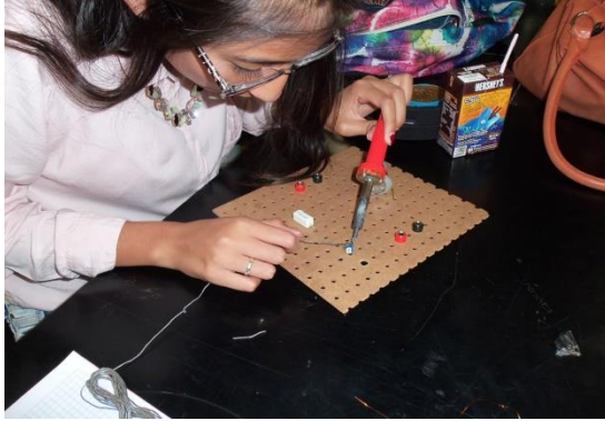
Figura 4.36. Soldadura en los elementos del circuito.
