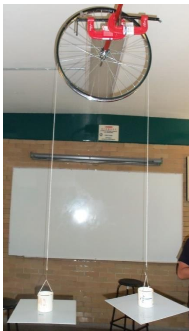
Figura 1. Sistema mecánico (máquina de Atwood) ya ensamblado en el aula de clase.
