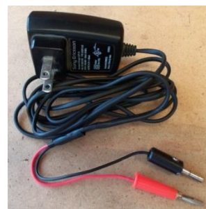
Figura 6. Cargador de celular adaptado con conectores banana.
