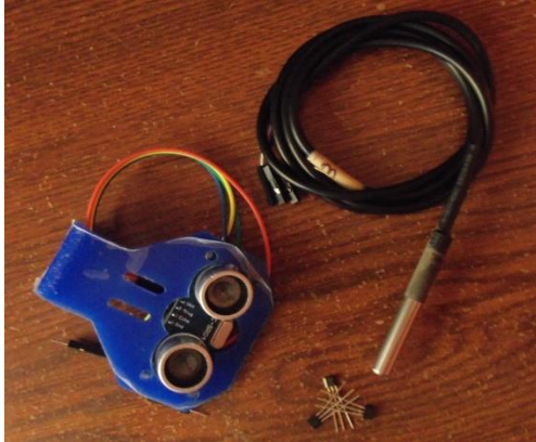
Figura 4.5. Izquierda sensor de posición, derecha sensor de temperatura e inferior sensor de campo magnético.
