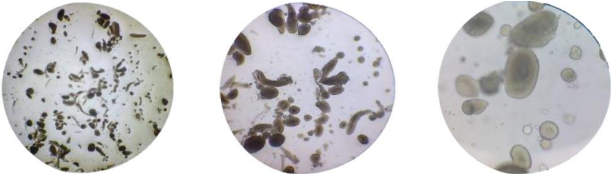
Figura 16. Micropartículas lipídicas sólidas de clorhidrato de ranitidina fabricadas por el método emulsión en caliente a 0.10, 0.25 y 0.40 aumentos (respectivamente).
