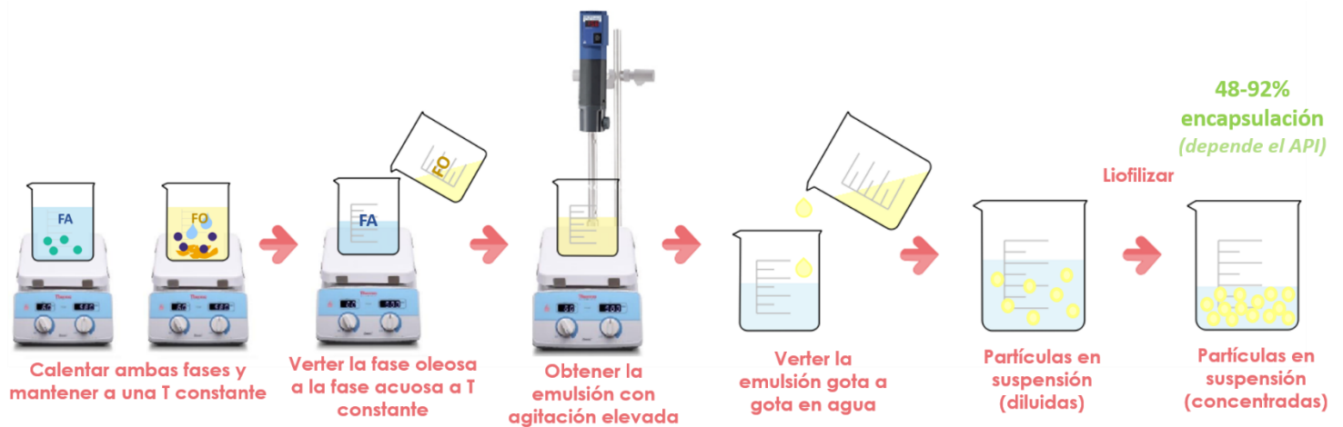
Figura 3. Método de obtención de micropartículas lipídicas sólidas por emulsificación-difusión, el porcentaje de encapsulamiento varía según las propiedades del principio activo que se emplee (Crespo, J.F. 2015).
