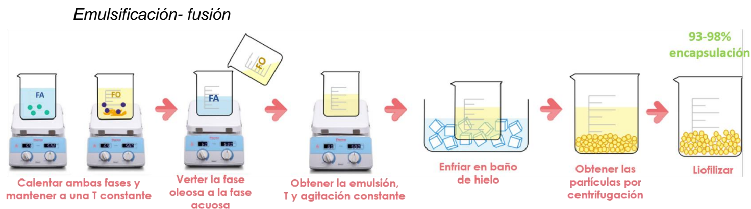
Figura 4. Método de obtención de micropartículas lipídicas sólidas por emulsificación-fusión o emulsión en caliente (Dalpiaz, A., et al. 2008; Perge, L., et al. 2012; Sznitowska, M. et al. 2017)
