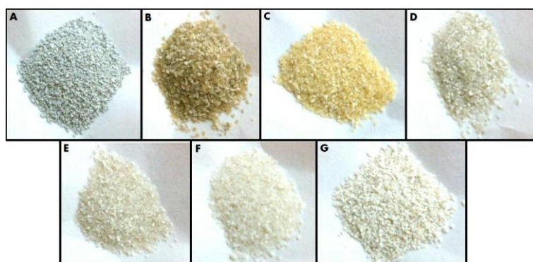
Figura 18: Muestras después de reacción usando 0.2 g de catalizador en corridas a 200, 300 y 350 °C. A) AI0, B) AI90, C) AI92, D) AI94, E) AI96, F) AI98, G) AI100
