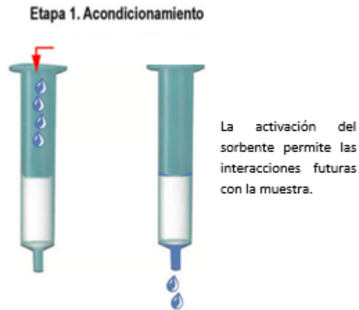
Figura 10. Acondicionamiento de cartucho en EFS 35 .
