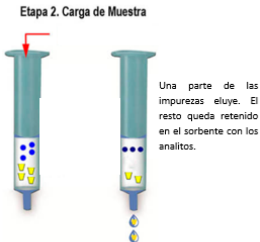
Figura 11. Carga de la muestra en EFS 35 .
