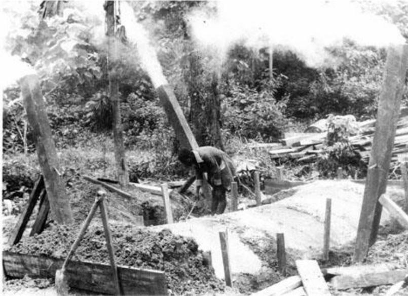
*Figura 2. Horno de tierra para la elaboración de carbón vegetal, FAO 1983*
