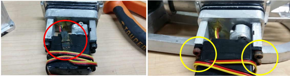
Figura 6.2 Terminales (resaltado en rojo) y tornillos dañados(resaltado en amarillo) por la filtración de agua en los servomotores.
