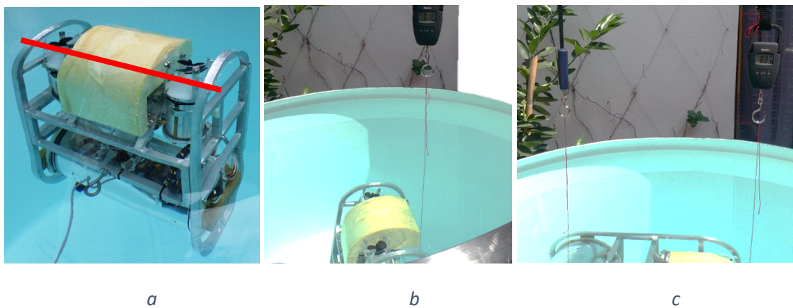
Figura 6.14 a) Robot flotando (la línea roja indica el nivel de agua), b) sumergido y jalado por un dinamómetro, c) sumergido y nivelado por dos dinamómetros.
