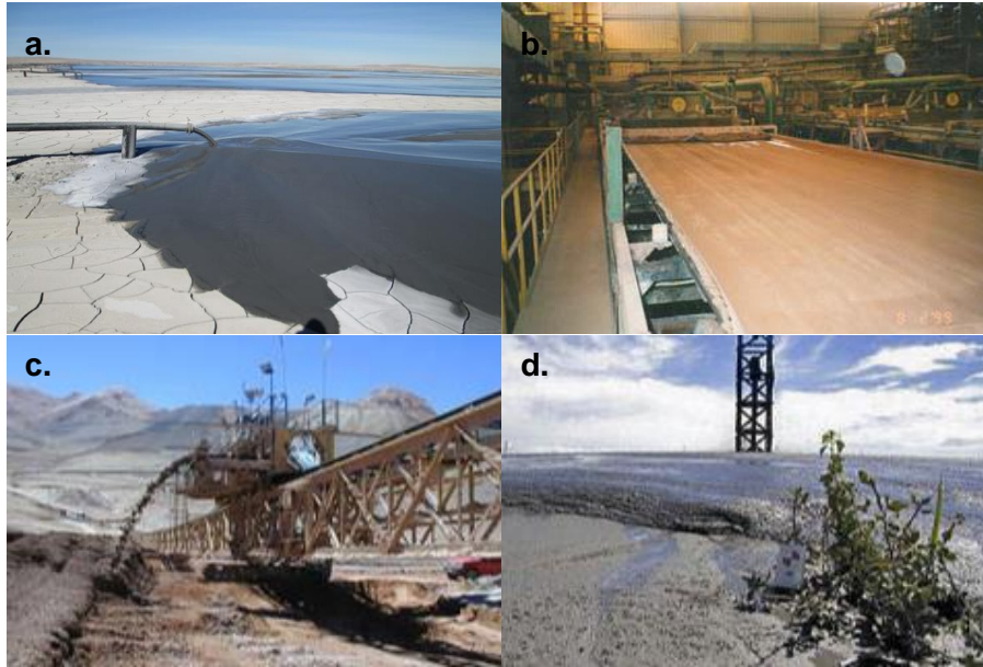
Figura 2.13: a) Descarga de relaves espesados, b) filtrado de relaves, c) descarga de relaves filtrados, y d) relaves en pasta (Engels, 2017; Martin et al., 2002).
