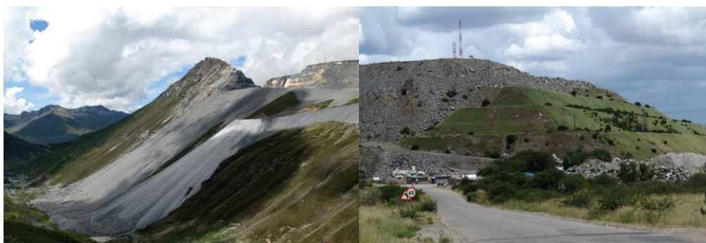
Figura 8.3: a) Vertedero de rocas adyacente a un valle y b) recuperación de vertedero de rocas de desecho en etapa de cierre (Hawley y Cuning, 2017).
