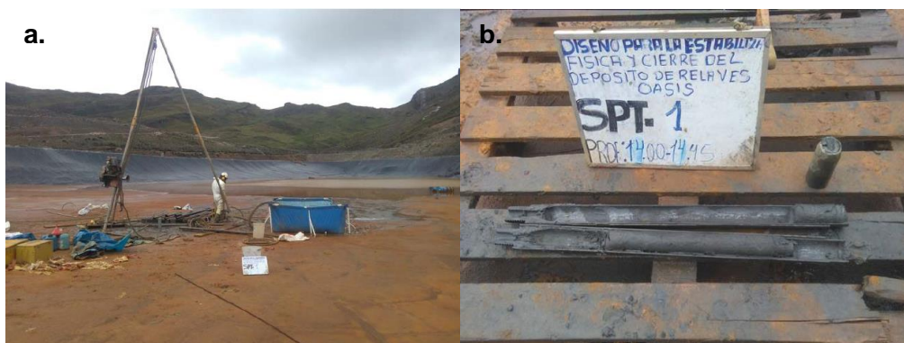
Figura 9.7: a) Sondeo de penetración estándar y b) muestra recuperada con tubo de caña partida, dentro del depósito de relaves Oasis (Nysrtar, 2017).
