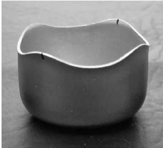
Figura 2.16 Fenómeno de *earing* producido por un proceso de embutido [36].
