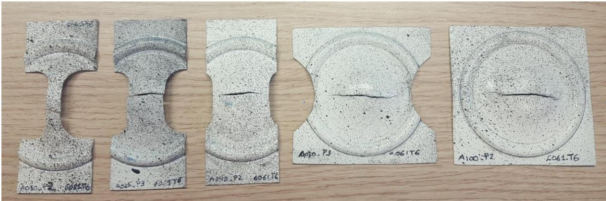
Figura 2.26 Geometrías empleadas para generar diferentes estados de deformación en un ensayo Erichsen.
