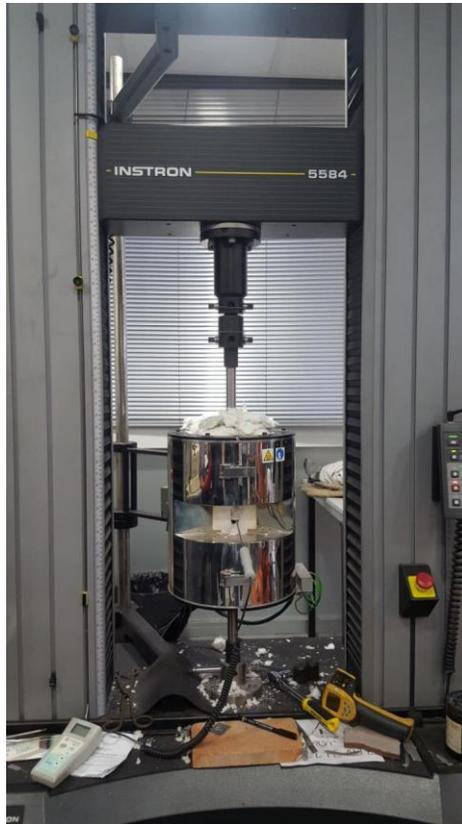
Figura 2.24 Máquina universal de ensayos Instron 5584.
