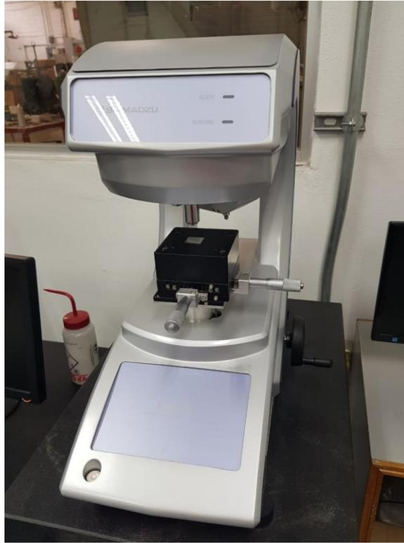
**Figura 2.10 Durómetro modelo Shimadzu.**
