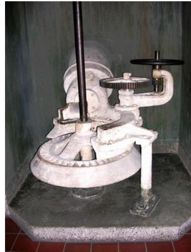
Ilustración 19 Girard-Turbine, Escher, Whyss & Vo., Zürich, 1885. La turbina exhibida tiene admisión parcial: como máximo, 9 de las 39 células del corredor son golpeadas simultáneamente por el agua. Para regular la turbina, este número se reduce cubriendo los conductos de guía con una válvula deslizante. La válvula deslizante se maneja con el volante a la derecha. Impluse turbine Head: 10 m Velocidad: 200 min -1 Flujo de agua: 0.12 m 3 s -1 Potencia: 8.8 kW
