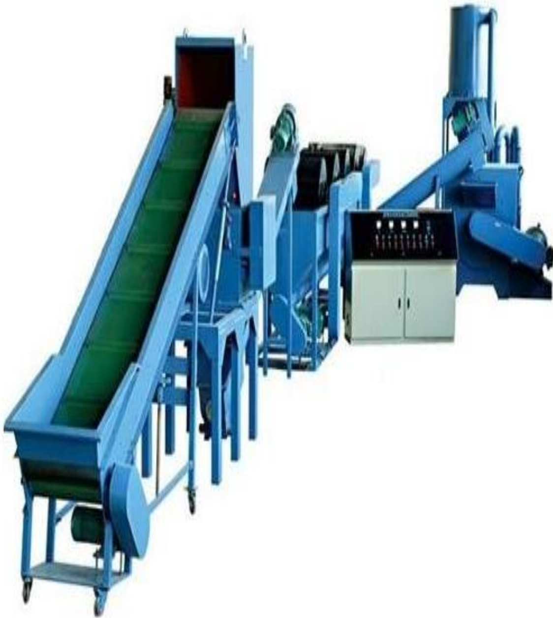
Imagen 2.14: Túnel de Fricción y Lavado
