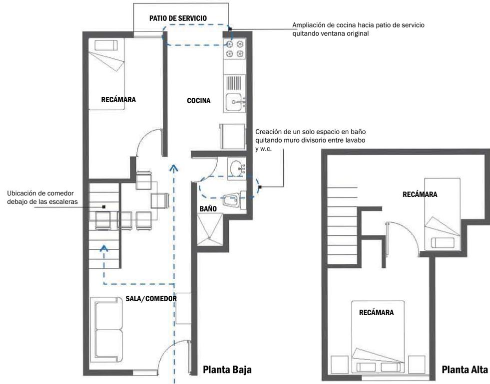
3.1.6 Planta arquitectónica prototipo C modificado
