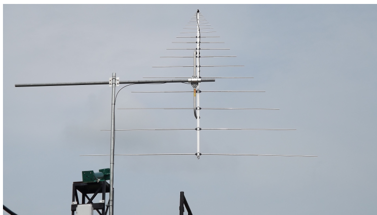
Figura 3.1: Fotografía de la antena LPDA que usa Callisto-MEXART, el TMA-1 que recibe la señal de Callisto se encuentra en la parte inferior en el castillo que sujeta el soporte de la antena.
