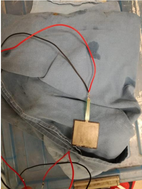
Figura 7. Sensor de fuerza de presión, Rango de fuerza soportado 10gr a 10 kg, dimensiones 43 x 43
