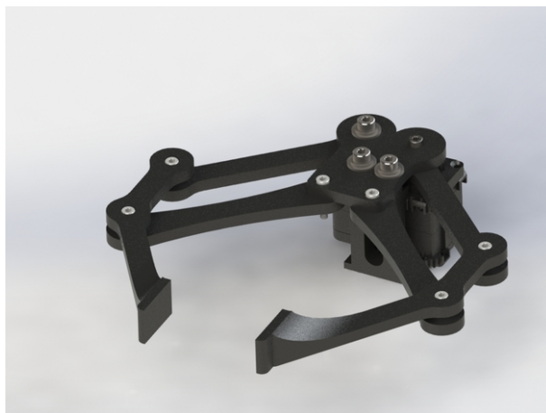
Figura 5.4: Esquema 3D de la tenaza prototipo para esta aplicación.
