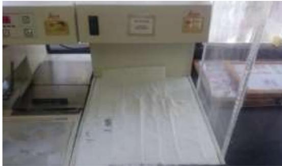
**Figura A.2.9.** Sistema modular de inclusión de tejidos marca Leica Biosystems® modelo EG1150 (B)
