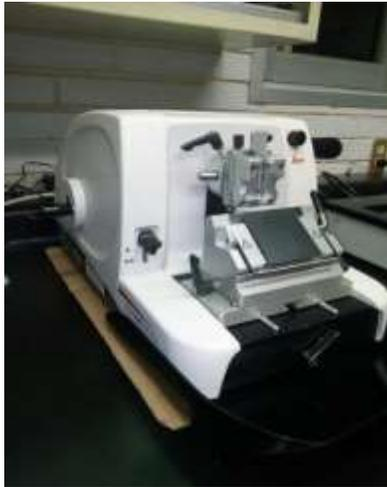
**Figura A.2.7.** Microtomo rotatorio de marca Leica Biosystems® modelo RM2125 RTS
