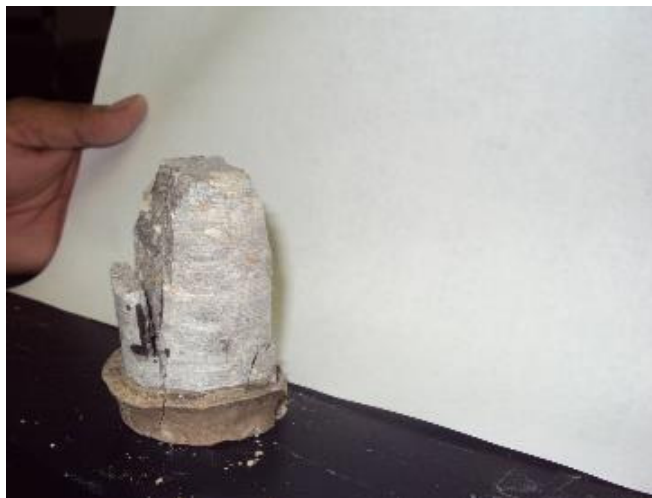
Figura 31. Muestra sometida a la prueba de compresión simple.
