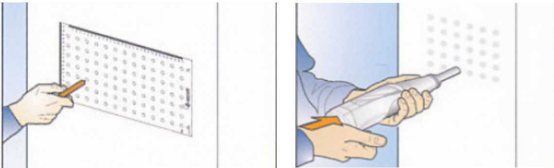
Figura 25. Aplicación de esclerómetro de acuerdo a retícula marcada en elemento de concreto. (IMCYC, Tomo 19, Determinación del Índice de rebote utilizando el dispositivo conocido como Esclerómetro, Marzo 2009.)
