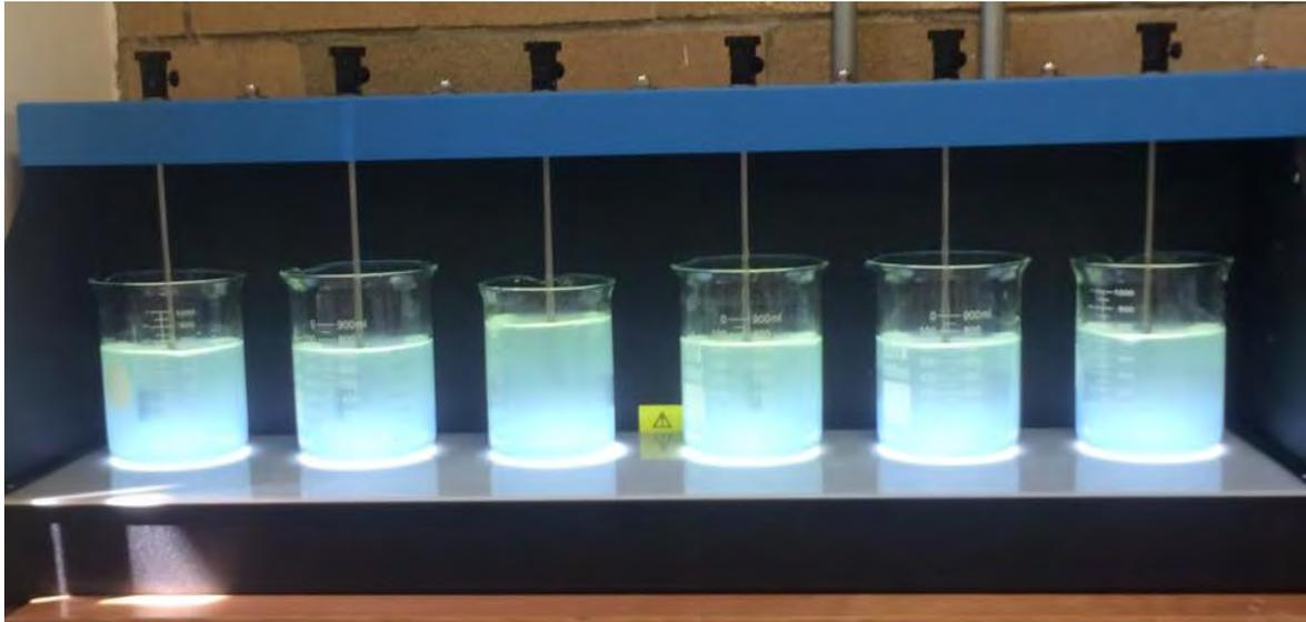
**Figura 7.** Prueba de jarras para pre tratamiento por coagulación floculación.
