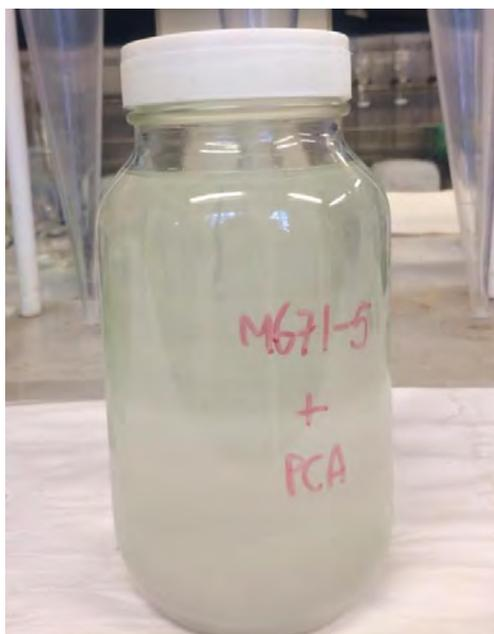
**Figura 9.** Agua congénita pre tratada con PCA antes del tratamiento de electrocoagulación.
