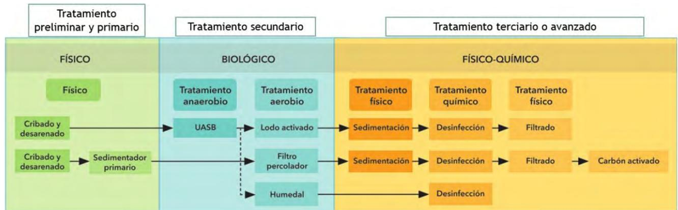
Figura 3. Integración del proceso de tratamiento de agua residual con algunos ejemplos de métodos. Tomado de Noyola, Morgan y Güereca (2013).
