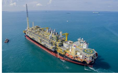
**Figura 1.6:** Sistema flotante de producción tipo FPSO
