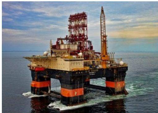
**Figura 1.3:** Plataforma tipo semi-sumergible
