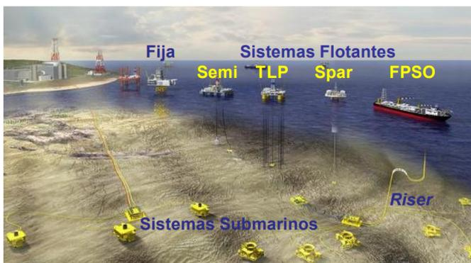
**Figura 1.2:** Sistemas flotantes costa afuera
