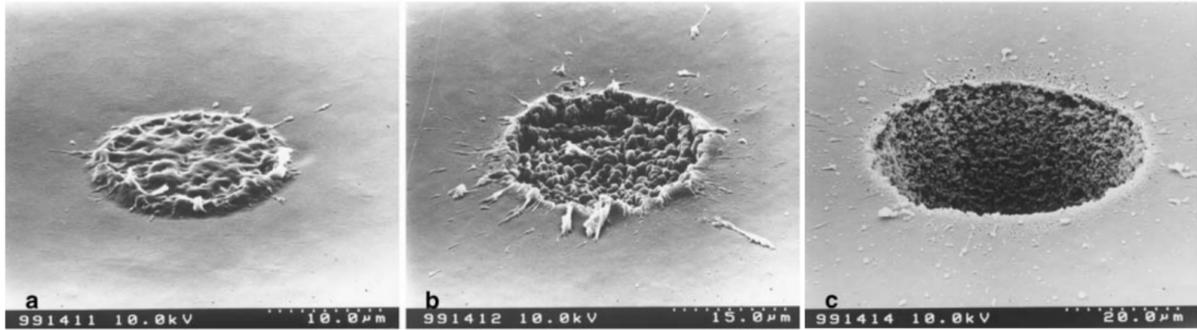
Figura 1.14. Grabados hechos por ablación láser en PMMA con un láser de Ti:Sa de 800nm a 150fs modificando el número de pulsos N: a) N=1. b) N=5. c) N=100.
