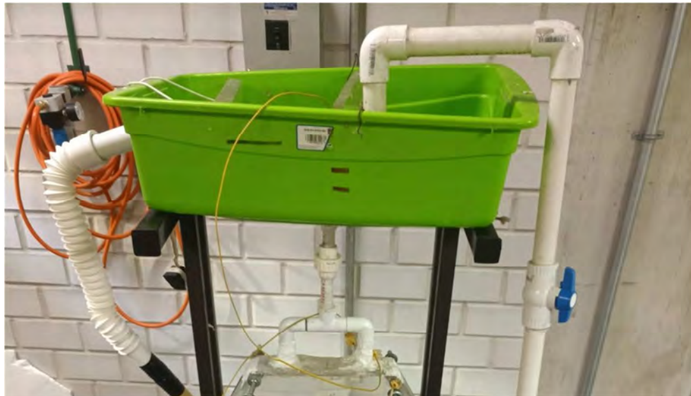
Figura 2.6 Parte superior del dispositivo donde se encuentra el área de enfriamiento
