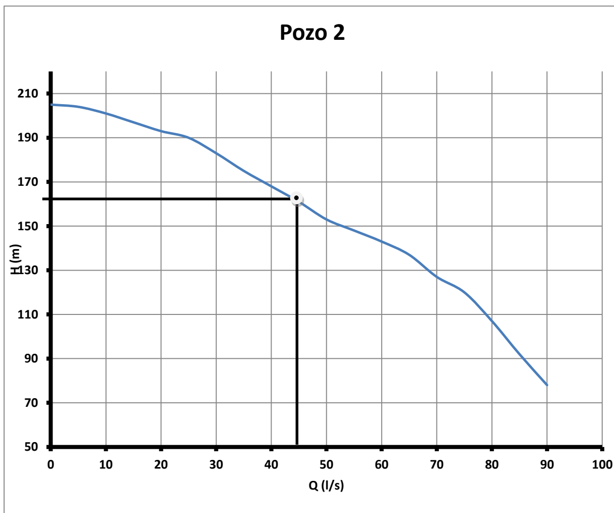
Figura 4.4 Curva característica, equipo de bombeo pozo 2.
