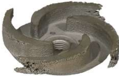
Figura 1-8.- Efectos de cavitación de impulsión.
