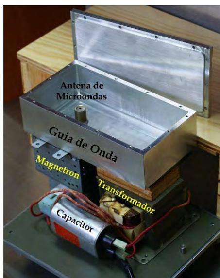
Figura 12. Dispositivo experimental para radiar microondas controlando su potencia y por ende su energía.
