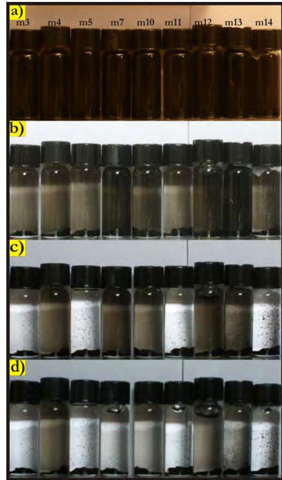
Figura 37 Se muestran las fotografías de NTCPM dispersos en agua a) después del baño de ultrasonido, b) a 5 hrs, c) a 4 días y d) 3 semanas después del baño ultrasonido.
