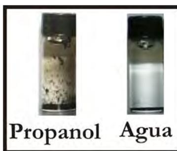
Figura 35. Muestras de referencia para nanotubos prístinos con propanol y Agua tridestilada después de 24 hrs.
