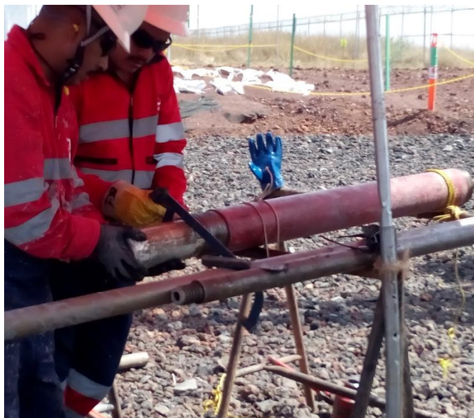
Figura 2.7 Tubo TGC, extracción de muestra de 20 cm
