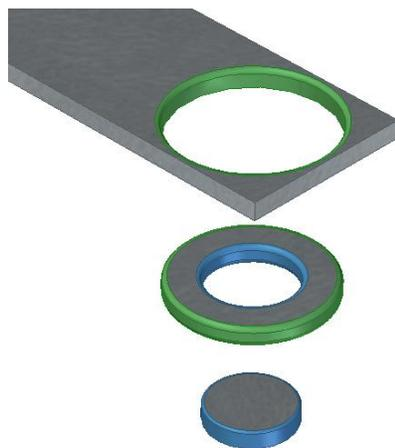
**Figura 13.** Diferencias entre operaciones de troquelado y punzonado. Considere que se desean obtener arandelas. En Azul, los bordes generados en punzonado, en el cual se genera el barreno central. En verde, los bordes producidos por el troquelado final.
