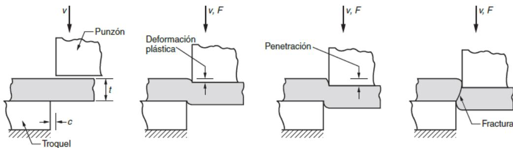
Figura 11: Fases del proceso de corte por cizalla
