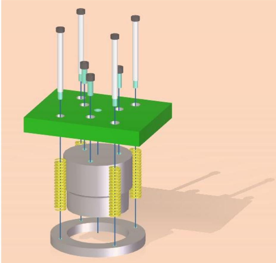
**Figura 31. Ensamble de la parte superior del herramental.**
