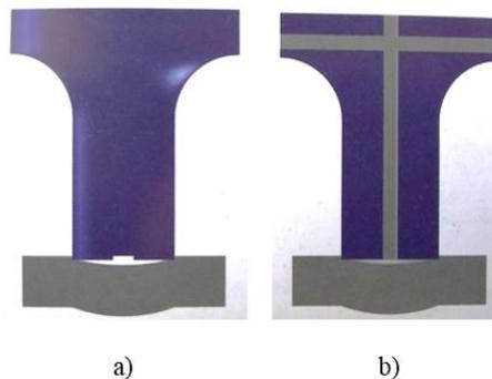
**Figura 15. Soluciones aplicadas en el elemento macho. a) Elemento ranurado b) Pasadores eyectores. Estas dos soluciones contrarrestan la adhesión del material desprendido. Fuente: The fabricator en español, verano 2016.**
