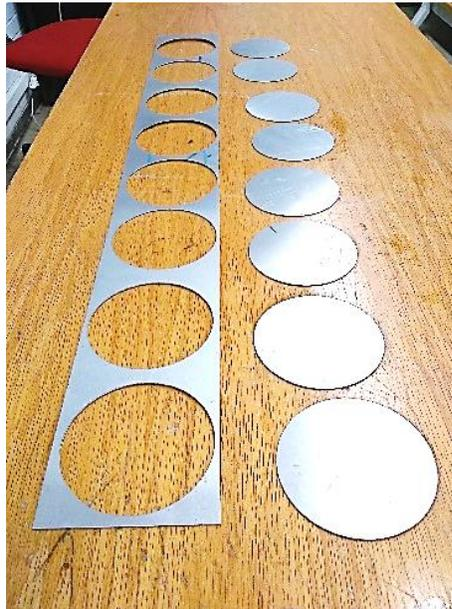
Figura 20. Configuración de cortes en las láminas.
