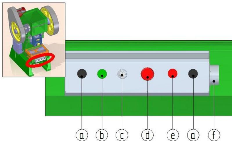
**Figura 35. Panel de control de la máquina. a) Botones de operación “Ambas manos” ubicados en los extremos de la botonera, b) Botón de arranque de motor, c) interruptor de encendido y selector de modo de operación, d) Botón paro de emergencia, e) Botón paro de motor, f) Conector de pie pedal,**
