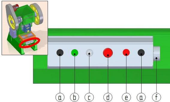
**Figura3. Panel de control de la máquina. a) Botones de operación “Ambas manos” ubicados en los extremos de la botonera, b) Botón de arranque de motor, c) interruptor de encendido y selector de modo de operación, d) Botón paro de emergencia, e) Botón paro de motor, f) Conector de pie pedal,**
