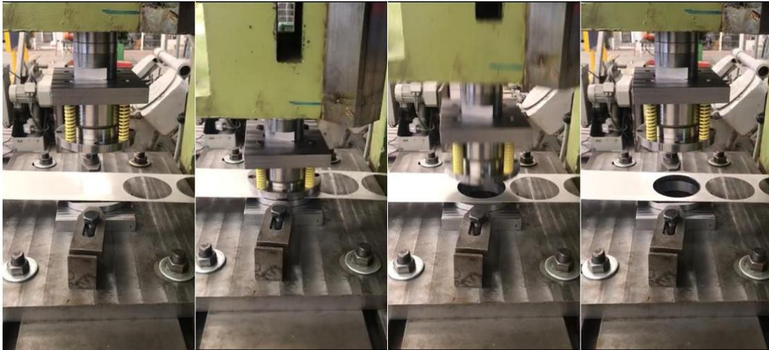
Figura 37. Secuencia capturada durante el proceso de corte.
