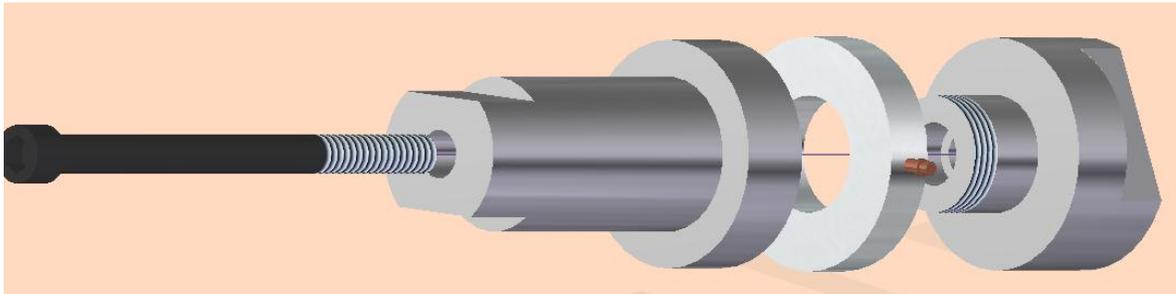
Figura 29. Esquema de ensamble del elemento instrumentado.
