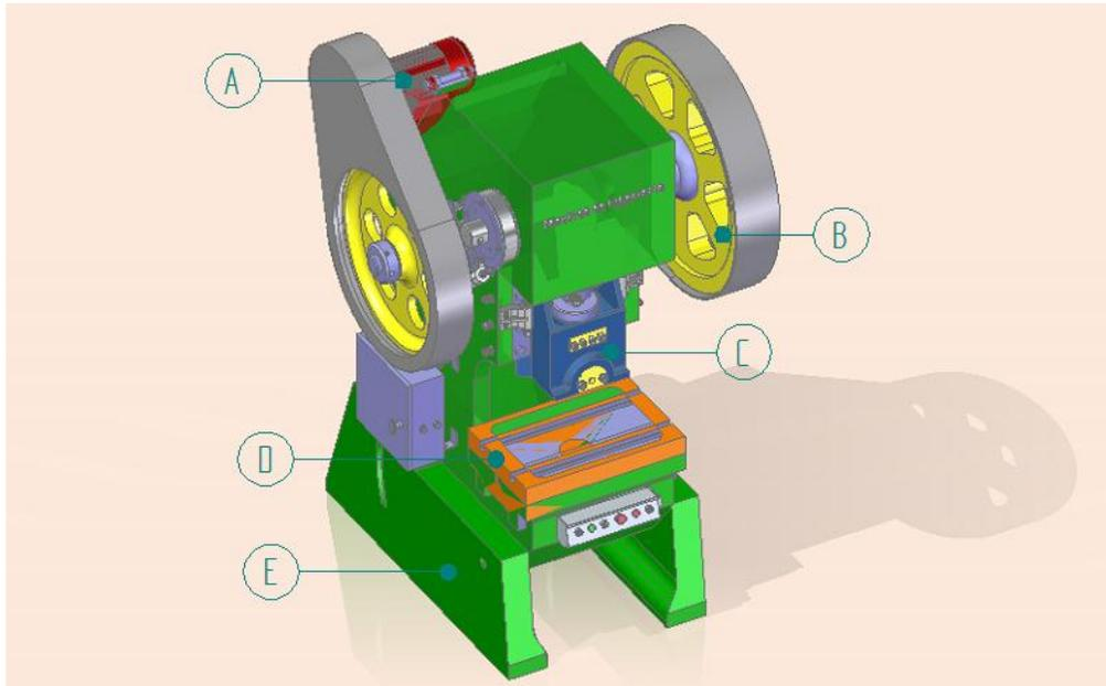
Figura 5. Prensa Troqueladora mecánica. A) Motor (rojo), B) Transmisión(amarillo), C) Pistón(azul), D) Cama(naranja), E) Armazón(verde).
