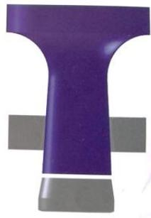
**Figura 17. Punzón de geometría conica. Reduce la fricción entre punzón lámina y matriz. Fuente: The fabricator en español, verano 2016.**
