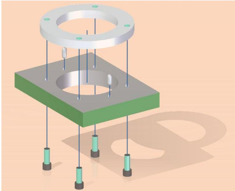
**Figura 30. Ensamble de la parte inferior del herramental.**
