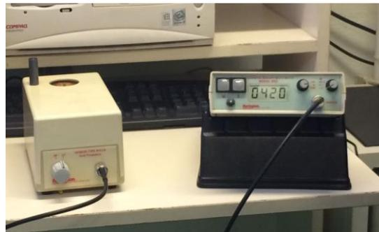
*Fig.12* Susceptibilímetro marca *Barrington MS2*
