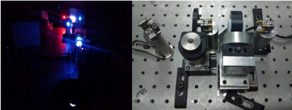
Figura 46.- Fotografías del fs-OPO en configuración SFC
