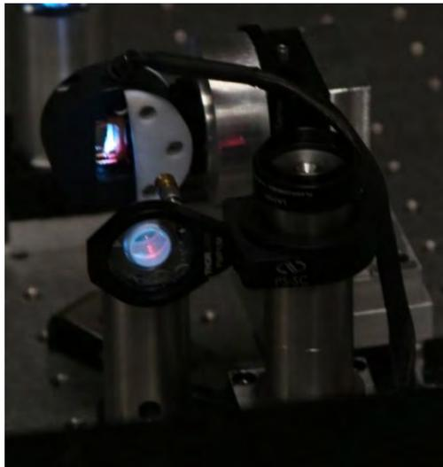
Figura 26. Fotografía del horno. (Izquierda) en la posición normal, se observa una de las tapas del horno; (Derecha) Girado 90° sin tapas.
