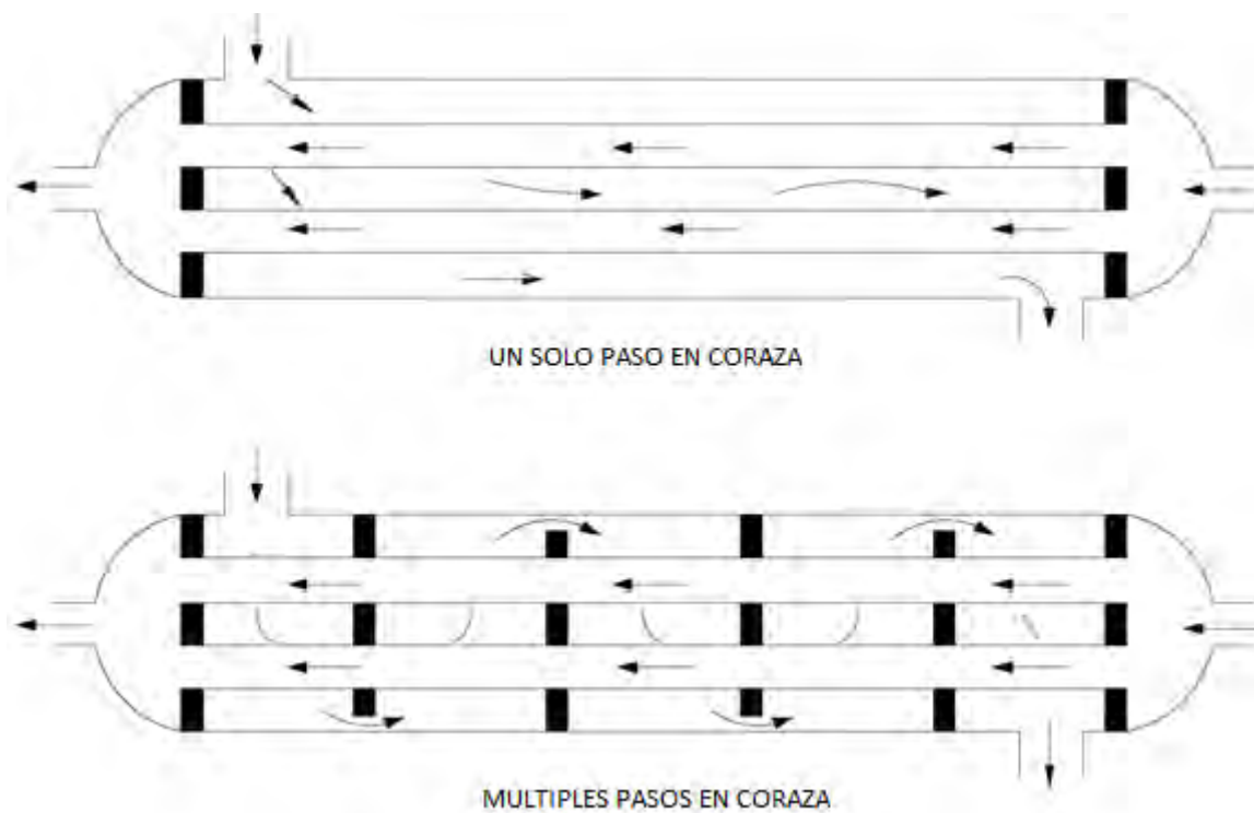
Fig. 11 Distribución de flujo cruzado con construcción de tubos y coraza con un solo paso en coraza y con pasos múltiples en coraza (Jaramillo Salgado, 2007).
