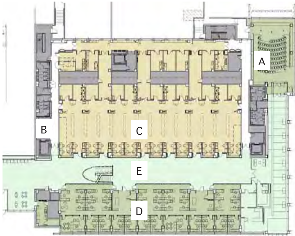
(Imagen 26, Planta tipo del Edificio B.) A) Auditorio. B) Circulación vertical y servicios. C) Dry Labs D) Wet Labs E) Circulación
