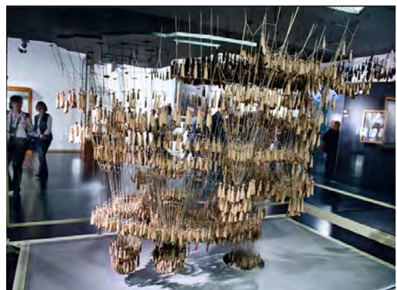
Imagen 5. Maqueta polifuncional. Recreación de la maqueta de Gaudí de la iglesia de Güell.
