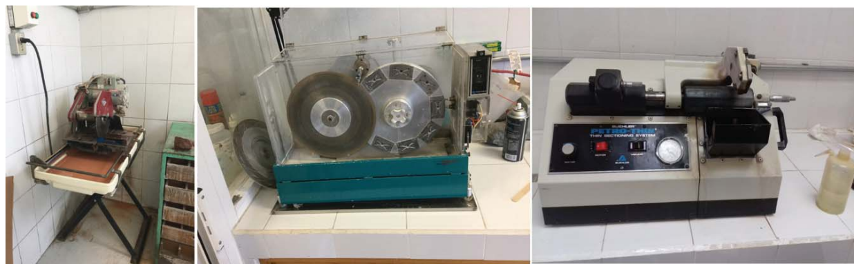
Figura 1.10. Maquinaria utilizada en el taller de laminación para la elaboración de secciones delgadas. Cortadora de disco cubierto de diamante, cortadora y desbastadora de secciones delgadas ya adheridas al portaobjetos y desbastadora de láminas delgadas hasta un espesor de ~30 \mu\text{m} .
