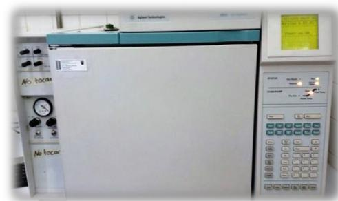
**Figura 8** Cromatógrafo de gases con detector FID utilizado en la determinación de ácidos grasos
