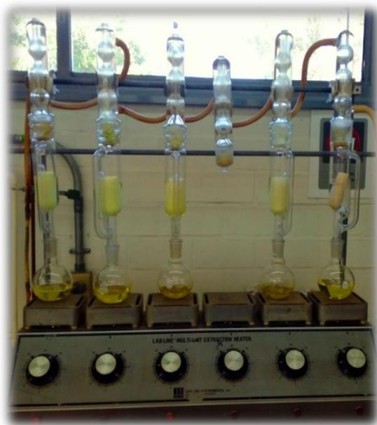
**Figura 4** Extracción Soxhlet con muestras de cáscara y semillas de aguacate Hass.
