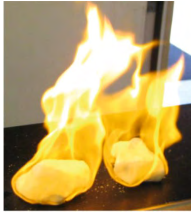
Fig. 3.6 Llama producida por la combustión del metano liberado por la disociación del hidrato. Tomada de C. Giavarini, K. Hester; Gas Hydrates: Immense Energy Potential and Environmental Challenges, Springer, 2011.
