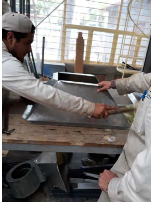
Fig. 150 Lamina doblada junto con las pestañas
