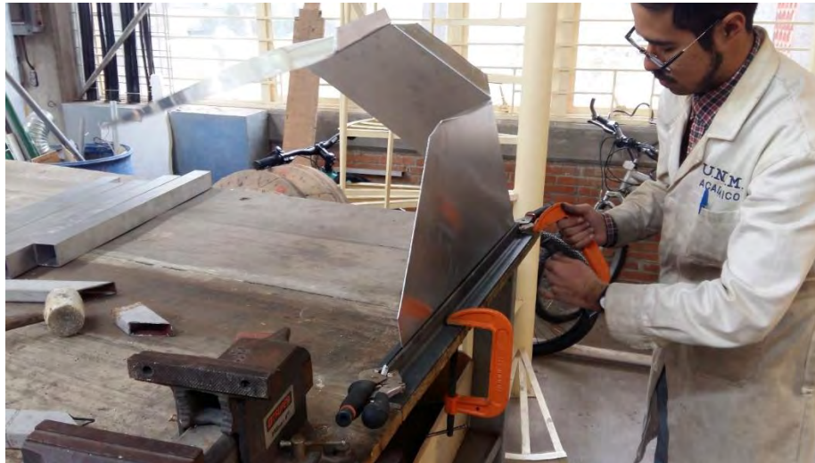
Fig. 140 Dobleces de las pestañas apoyados de tramos de ángulo de acero de 50.8 x 3.175 [mm] (2X1/8")
