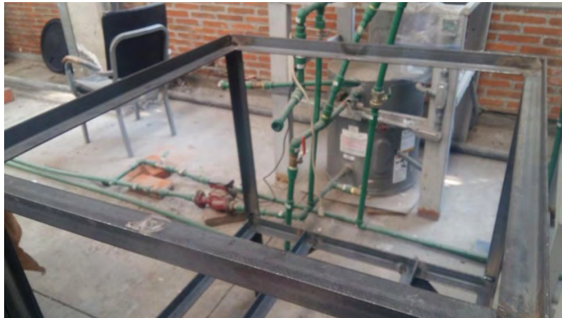
Fig. 119 Marco superior de la estructura soldado
