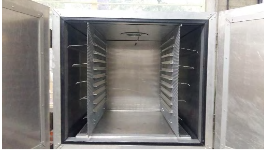
Fig. 117 Ensamble de los baffles en la lámina perforada
