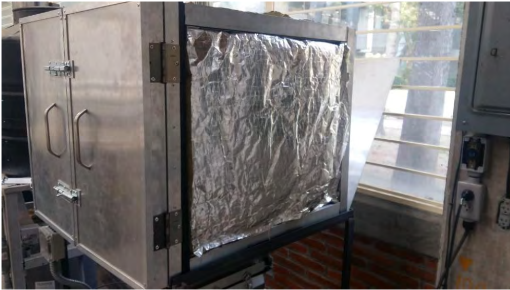
Fig. 103 Aislante en la pared derecha de la cámara
