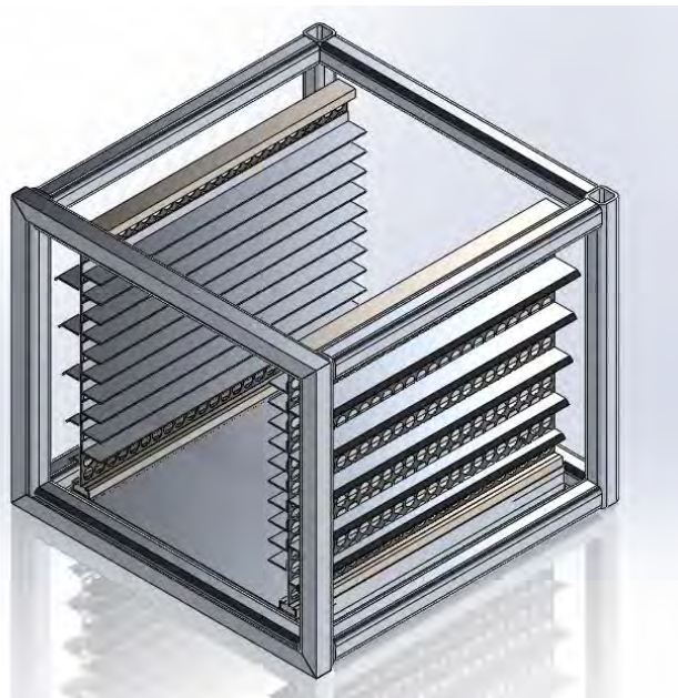
Fig. 48 Modelo 3D del ensamble de los espigueros en la lámina perforada
