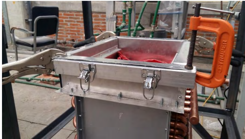
Fig. 160 Ensamble del ángulo de aluminio con la pestañas del ducto para limpieza
