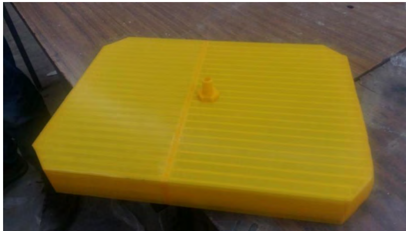
Fig. 166 Parte posterior de la tarja con el aditamento para colocarle una manguera de desagüe
