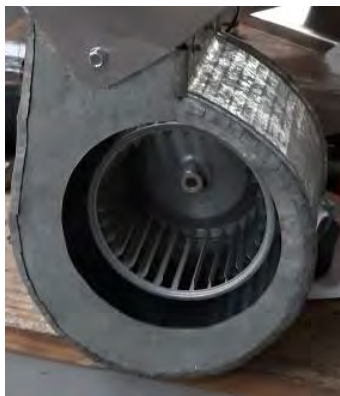
Fig. 76 Vista frontal del soplador
