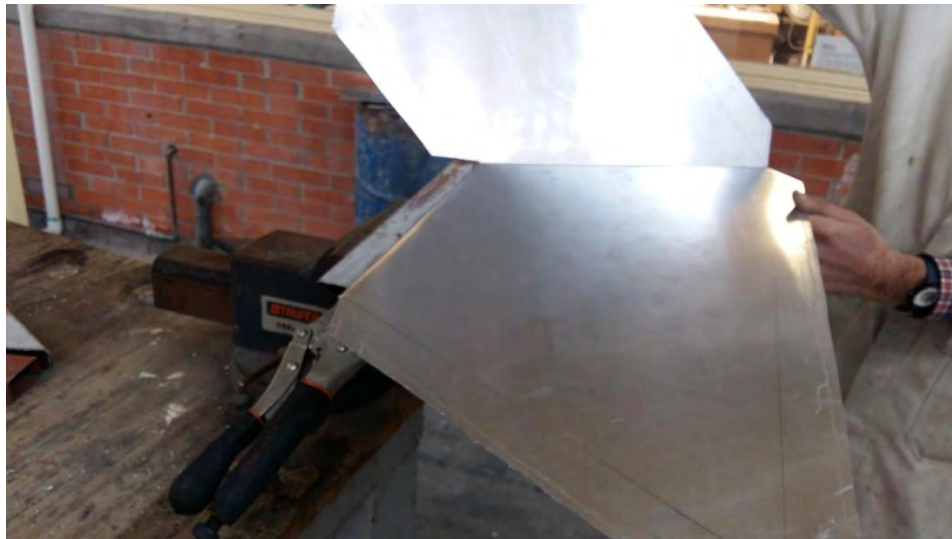
Fig. 139 Dobleces de las pestañas apoyadas de la prensa mecánica
