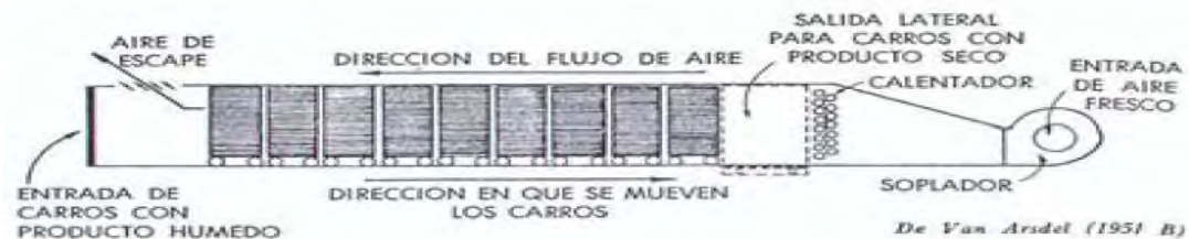
Fig. 4 Configuración de un deshidratador de túnel
