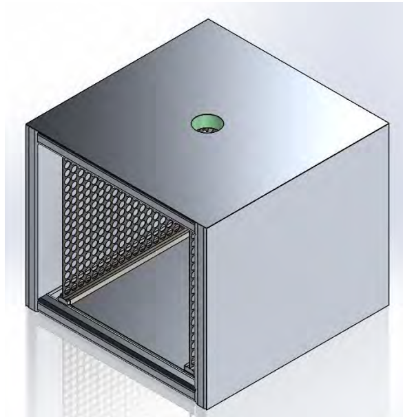
Fig. 24 Modelo 3D de la cámara de deshidratado
