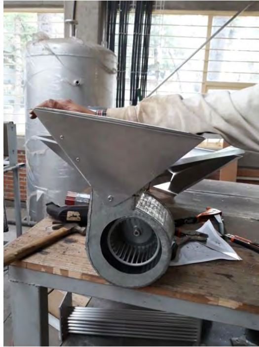
Fig. 142 Vista lateral del difusor ensamblado al soplador con tornillos autopercorantes y con sello de neopreno
