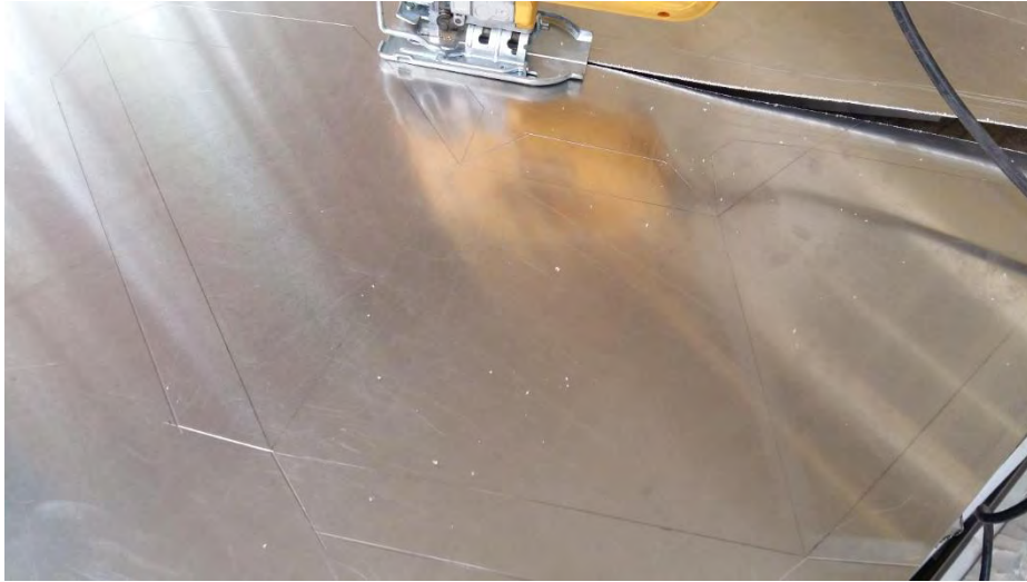
Fig. 134 Croquis de la Fig. 131 dibujado en lámina de aluminio y cortado con caladora
