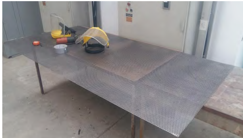
Fig. 110 Lámina perforada de acero al carbón cortada con esmeril
