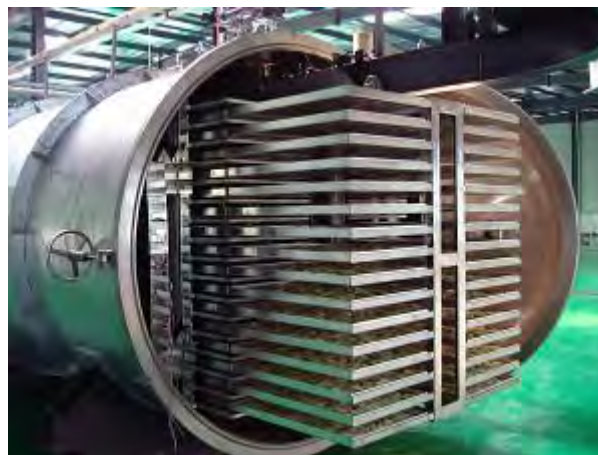
Fig. 10 Deshidratador por liofilización
