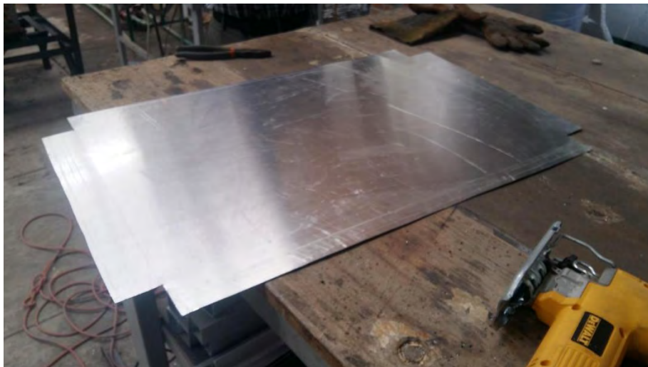
Fig. 81 Lámina cortada con pestañas para dobles
