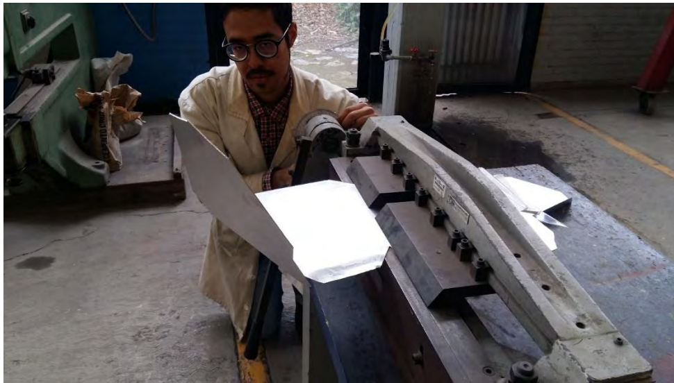
Fig. 137 Dobleces realizados con la ayuda de la dobladora de caja del CDM y con el apoyo de un transportador
