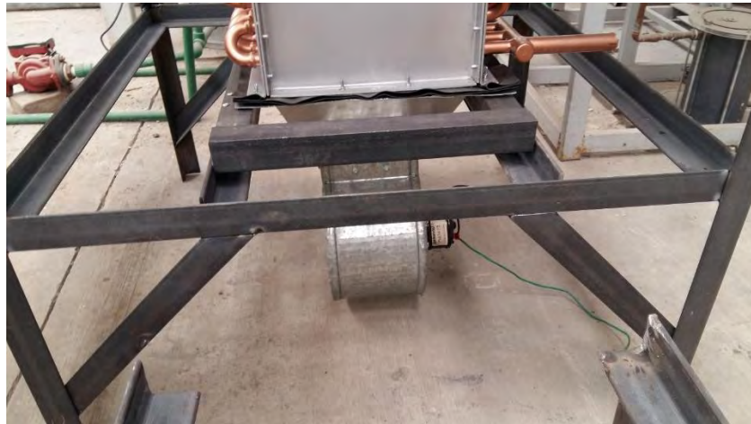
Fig. 125 Carriles colocados en el marco inferior, con parte frontal sobrante
