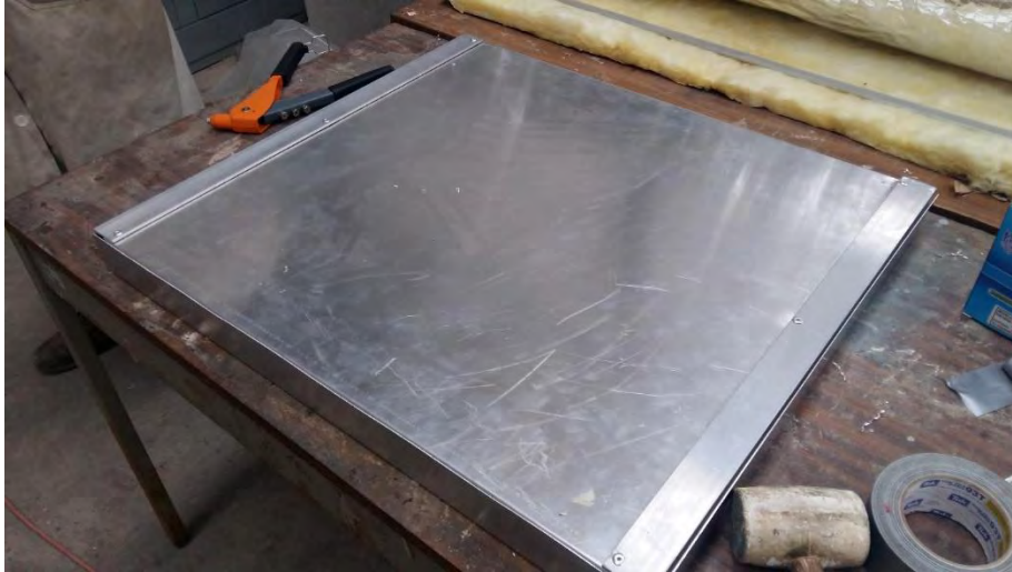
Fig. 107 Piso de la cámara de deshidratador terminado
