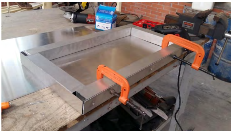
Fig. 94 marco interno de PTR 2x2 para brindar rigidez
