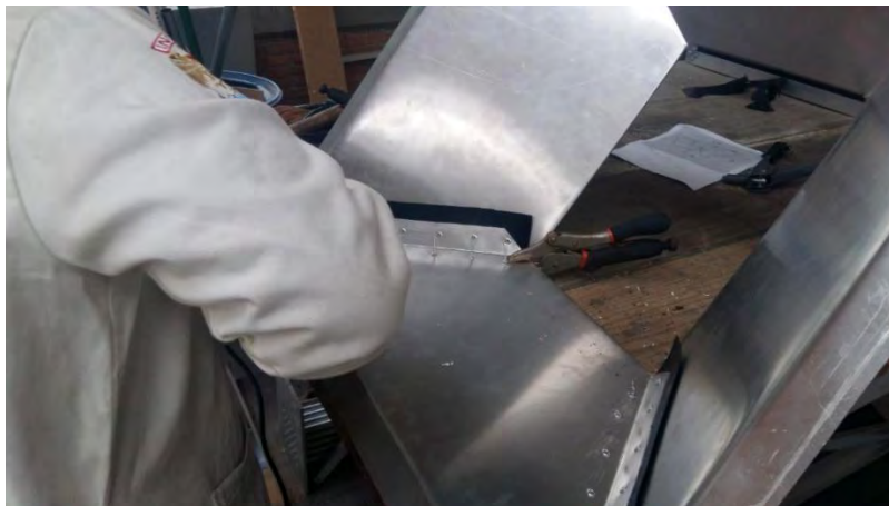
Fig. 151 Unión del difusor con su tapa para completar el ensamble
