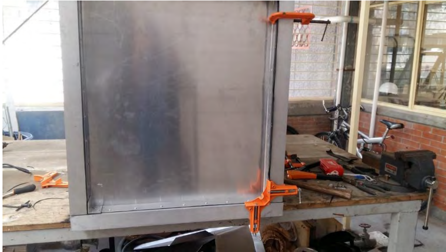
Fig. 84 Ensamble de las láminas de aluminio con el PTR para formar la estructura
