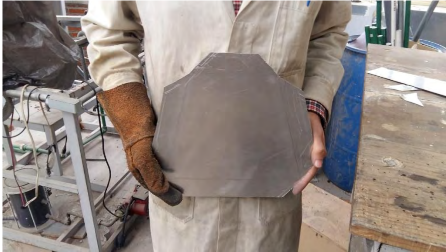
Fig. 136 Tapa cortada del difusor soplador-intercambiador de calor
