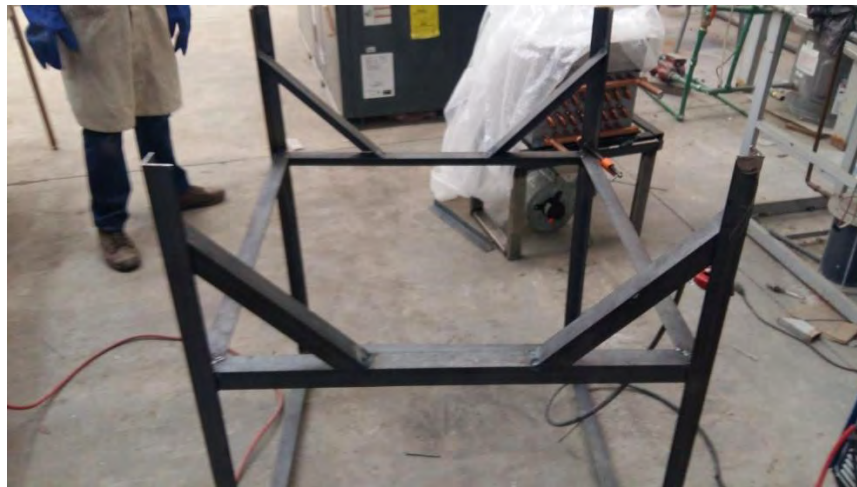
Fig. 123 Refuerzos a 45[°] soldados al marco inferior
