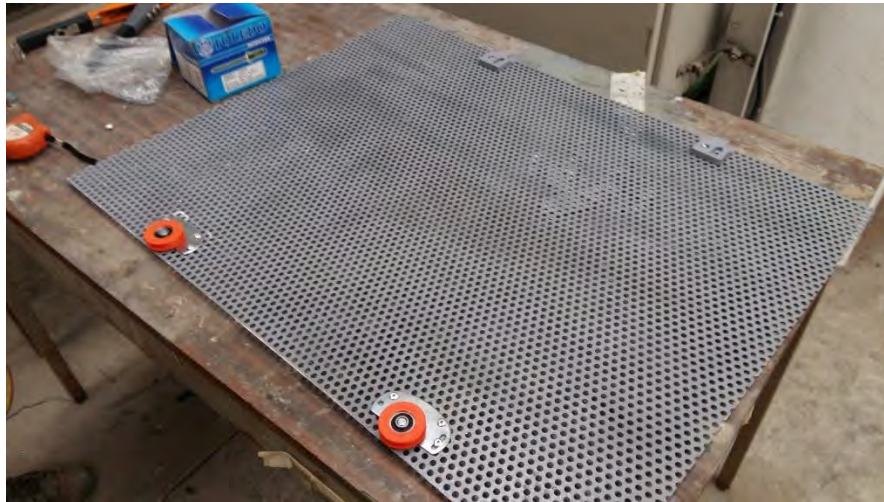
Fig. 111 Lámina de acero al carbón con rodamientos para los carriles de aluminio
