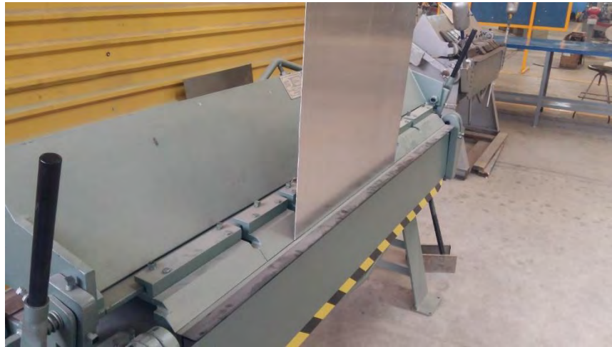
Fig. 82 Dobles de lámina en dobladora de caja en el CDM de la facultad de ingeniería de la UNAM
