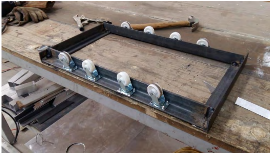
Fig. 171 8 ruedas instaladas para el deslizamiento del carrito en los carriles de la estructura del deshidratador
