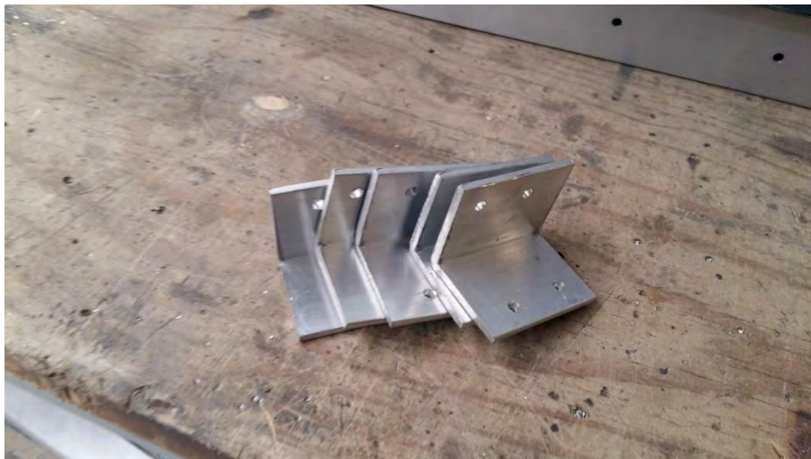
Fig. 80 Ángulos de aluminio cortados y barrenados
