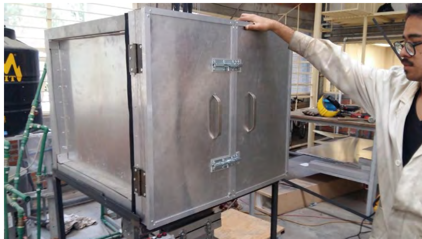
Fig. 102 Puerta terminadas junto con seguros de puertas corredizas instalados
