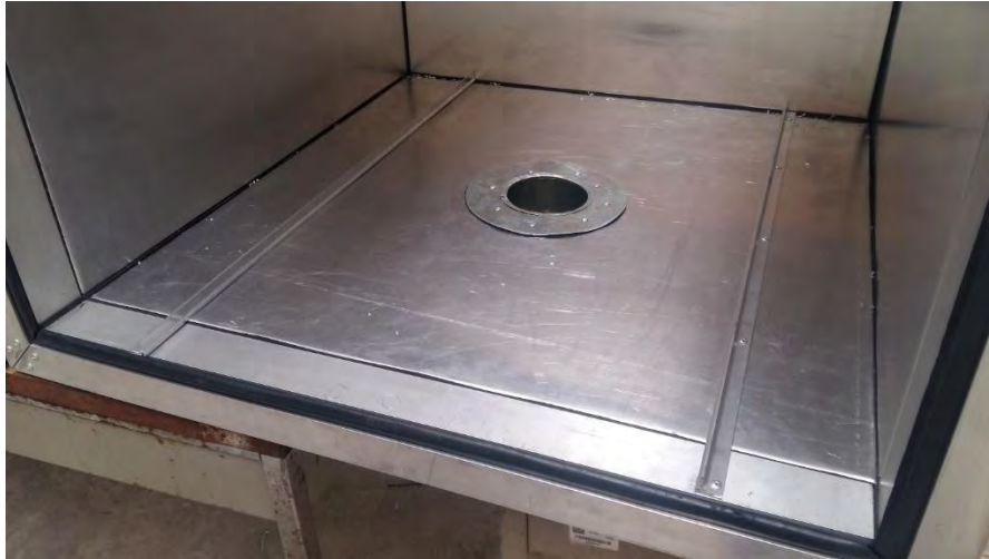
Fig. 109 Techo de la cámara de deshidratado con perfiles de aluminio para carriles de rodamientos
