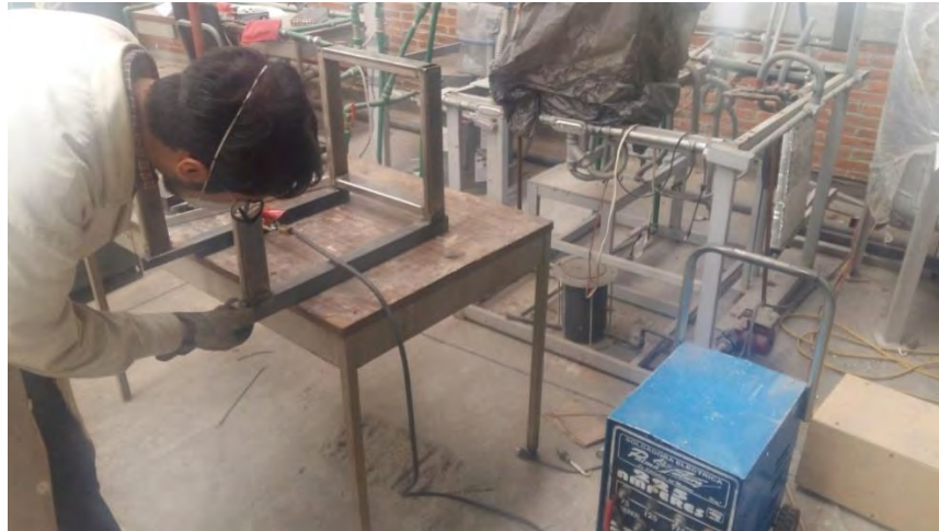
Fig. 173 Soldado de los tramos de acero para hacer el banco
