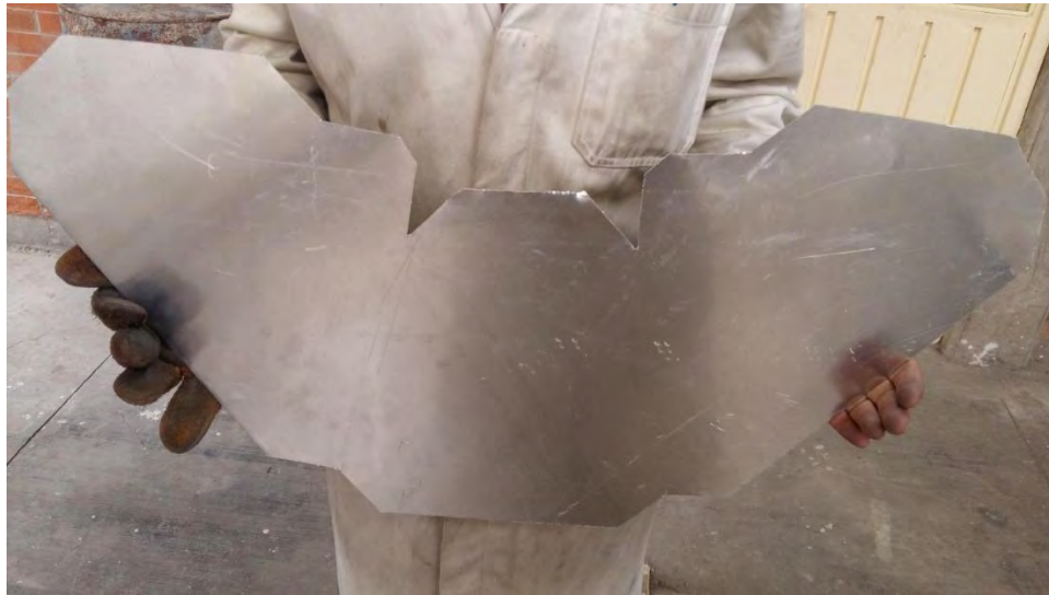
Fig. 135 Lámina cortada con la geometría para doblar
