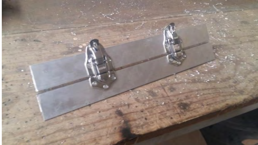
Fig. 159 Broches de baúl instalados en perfiles angulados de aluminio
