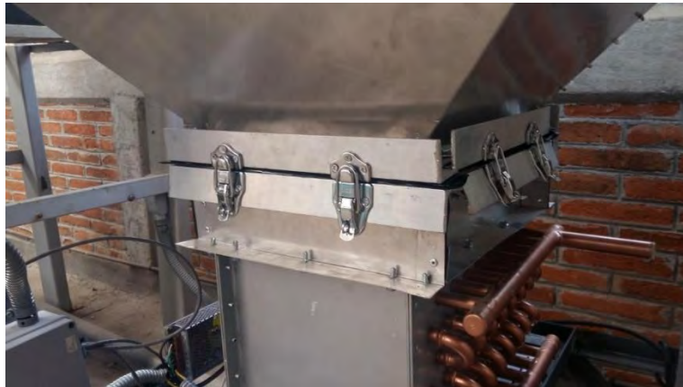
Fig. 161 4 pares de broches de baúl instalados para el fácil ensamble y desmontaje
