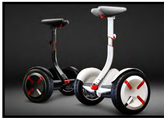
Fig. 4.5. Vehículo Segway con tecnología de giroscopios. [A2]
