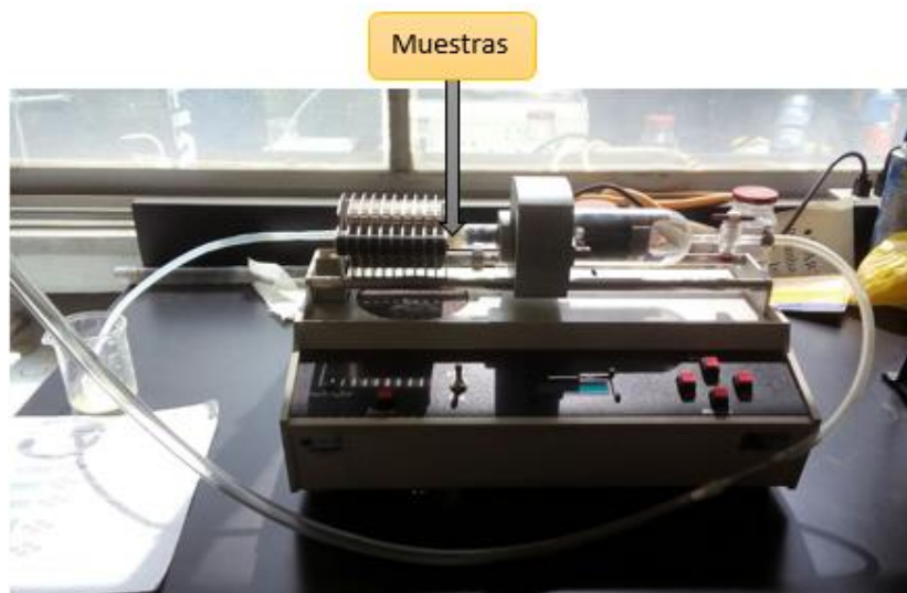
Figura 5.7. Termo balanza para el tratamiento térmico de los sensores.
