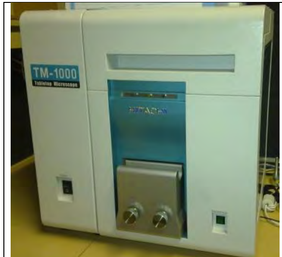
Figura 3. 4. Microscopio electrónico de barrido acoplado a un detector de energía dispersiva de rayos X (MEB-EDX), Hitachi Tabletop con procesador TM-1000
