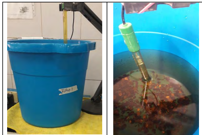
Figura 4. 8. Prueba de movilidad, muestra inicial 5 L de DAM
