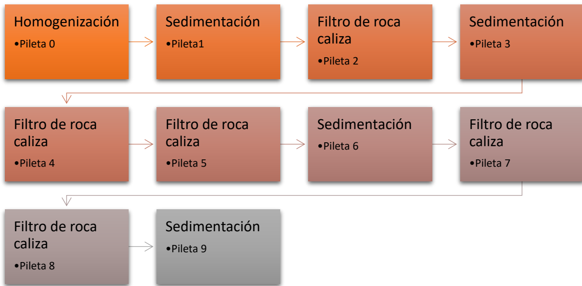
Figura 3. 3. Tratamiento pasivo in situ, sistema de piletas y su función
