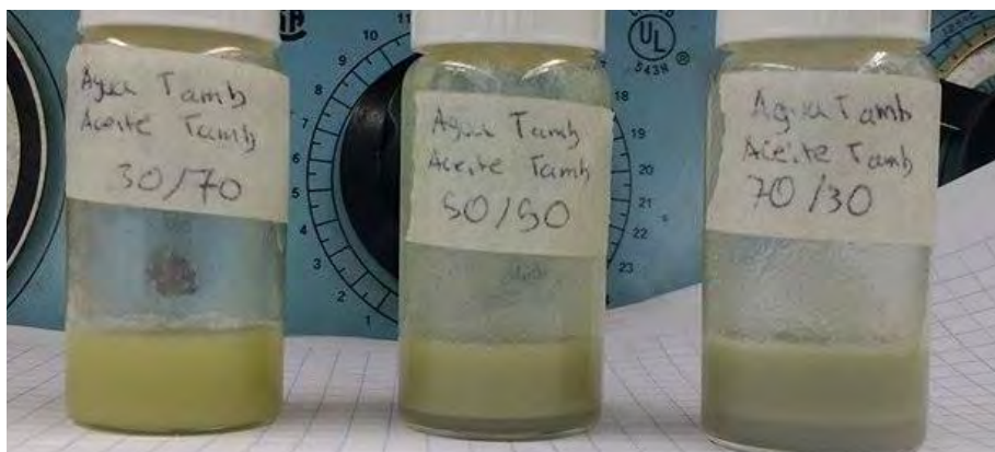
Figura 7.6. Ejemplo de emulsiones en pequeña escala, diferentes cortes agua-aceite y temperatura ambiente.
