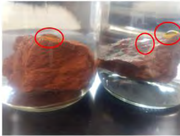
Figura 8.24. Día 15. Vista de lateral. Salmuera (izquierda) y nanofluido (derecha). En el caso de la salmuera se observa un ligero desprendimiento de aceite. En el nanofluido se observa mayor cantidad de aceite sobre la superficie de la roca.
