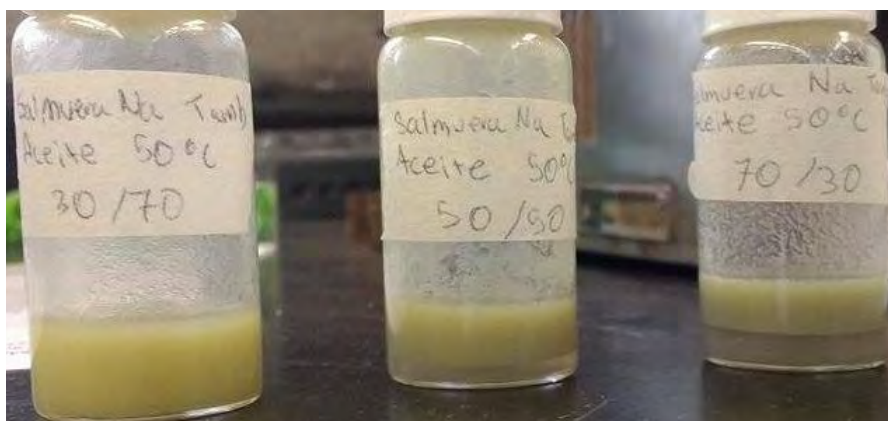
Figura 7.9. Emulsiones en pequeña escala, diferentes cortes agua-aceite y 50 °C de temperatura y salmuera de sodio.
