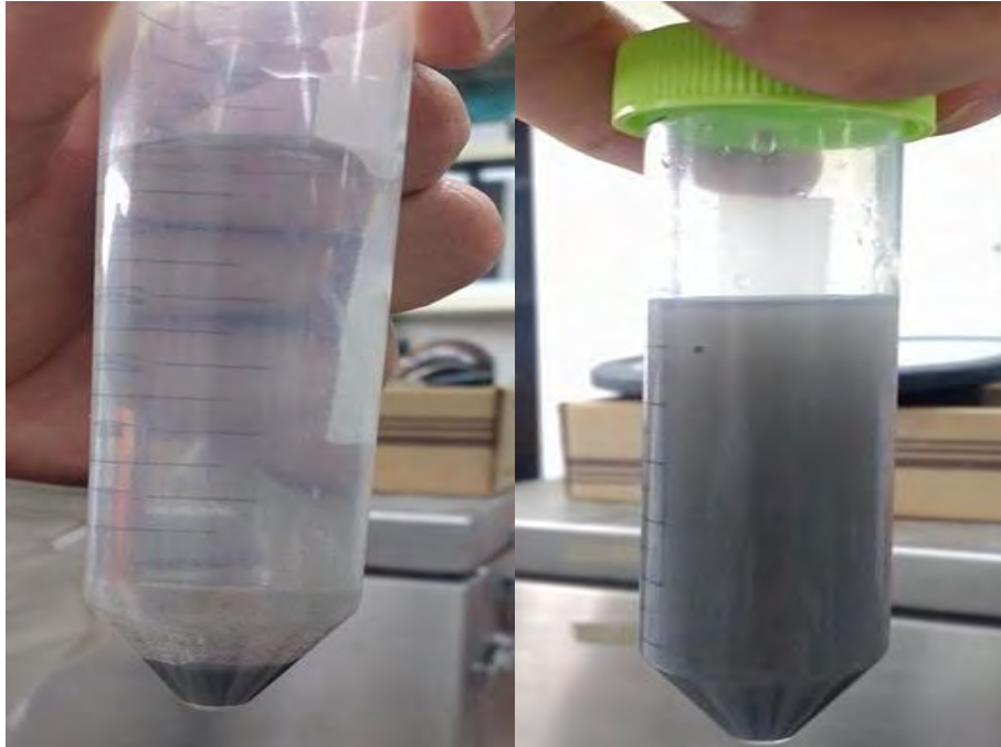
Figura 7.10. Nanopartículas en fase acuosa antes de suspensión (izquierda). Nanopartículas en fase acuosa después de suspensión (derecha).
