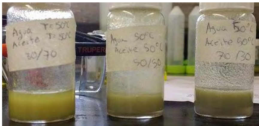
Figura 7.7. Emulsiones en pequeña escala, diferentes cortes agua-aceite y 50 °C de temperatura.
