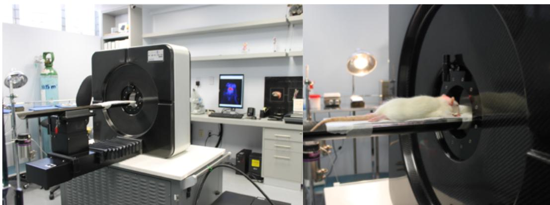
*Figura 1.2. MicroPET (izquierda) y posicionamiento de la rata anestesiada (derecha).*
