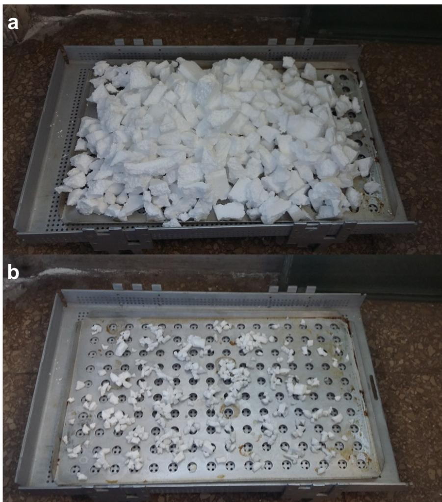
*Figura 15. Densificación de EPS obtenido a partir de material de desecho, (a) antes y (b) después del tratamiento térmico.*
