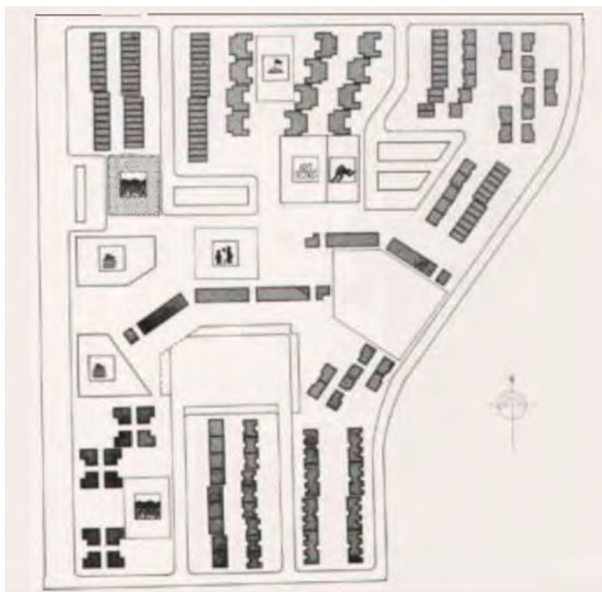
Imagen 1.7. "Planta de conjunto y sembrado de edificios de una super manzana: zona1 - agrupamiento".
