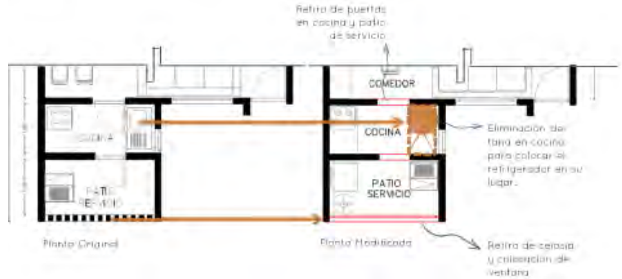
Imagen 4.18. Comparativa del estado actual con el original en la zona de servicios correspondientes a la cocina y el patio de servicio.
