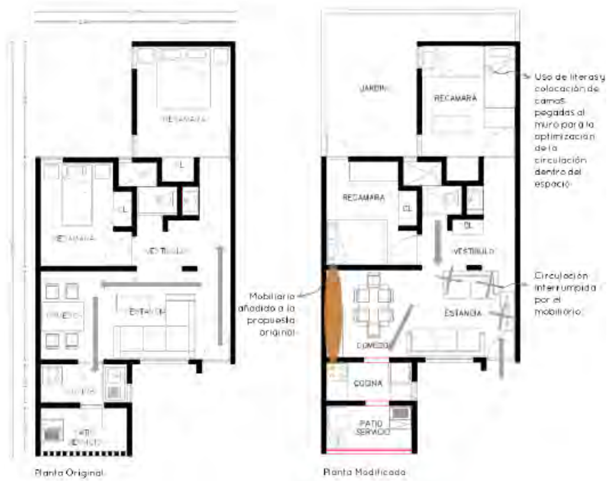
Imagen 4.19. Comparativa del estado actual con el original de toda la vivienda correspondiente al caso 5 en donde se marca cómo se modificó la circulación y el mobiliario que usaron para las adaptaciones del espacio.
