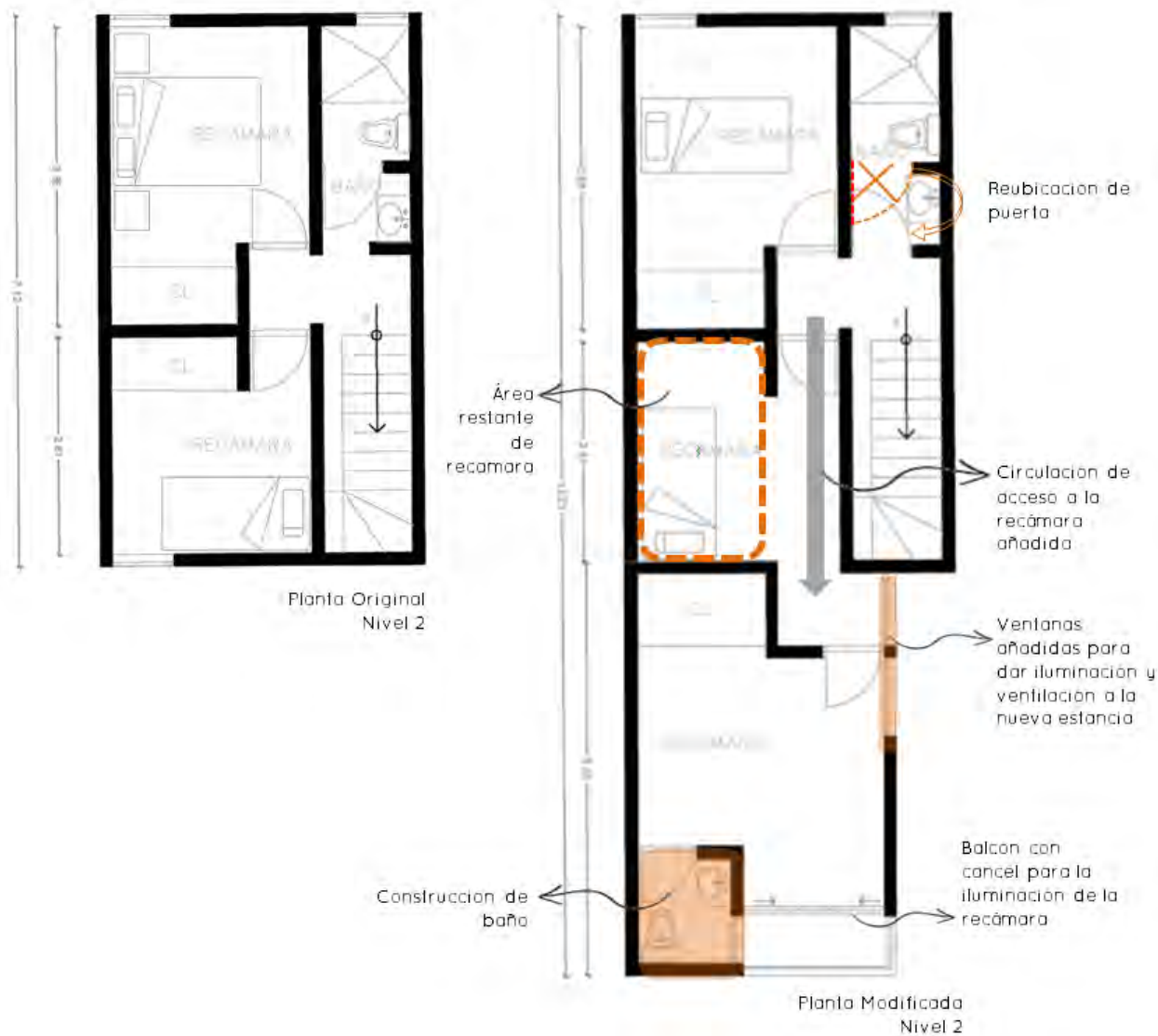
Imagen 4.42. Planta actual comparada con la original, indicando con color las modificaciones y elementos que agregaron en el área de las recámaras.
